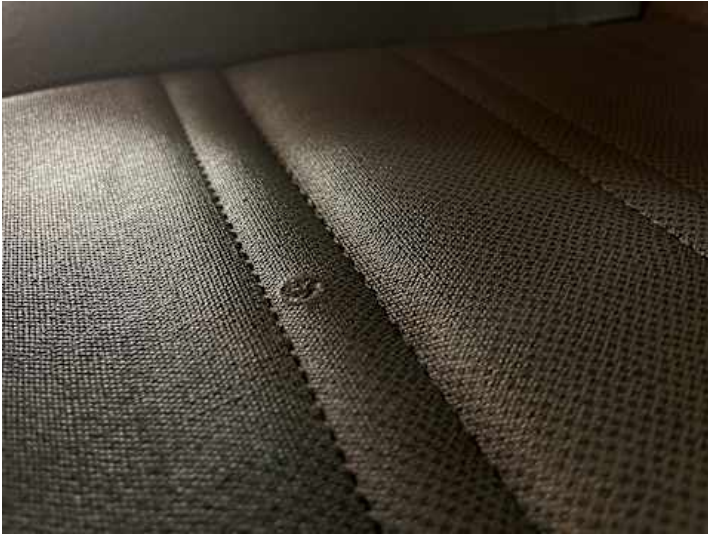
Innenraum (Verschmutzung, Verschleiß, Brandloch)
