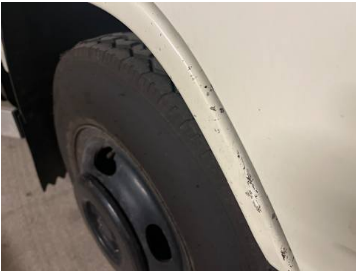
Kotflügel vorne rechts (Lackschaden)
