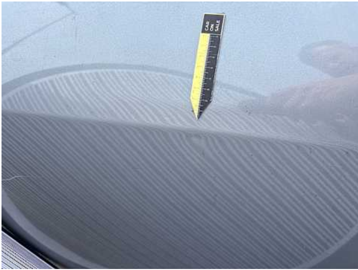
Türe hinten links (Delle, Verformung)
