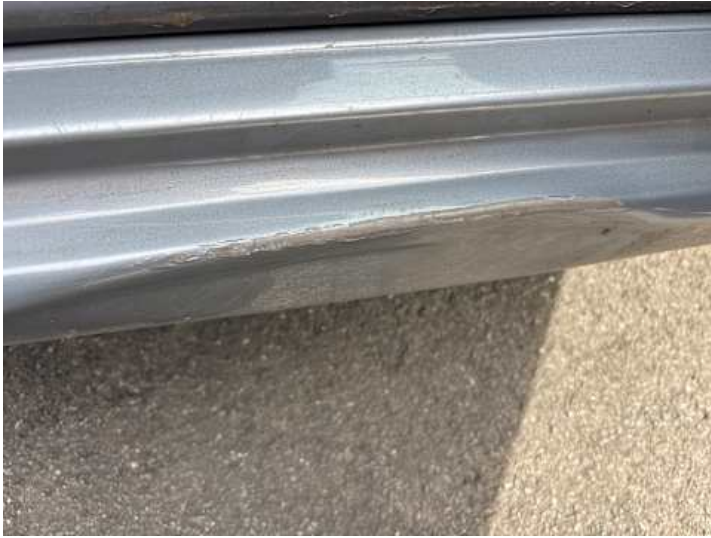
Schweller rechts (Verformung, Lackschaden)
