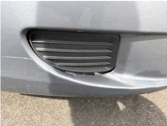
Stoßstange vorne (Riss/Bruch, Verformung)
