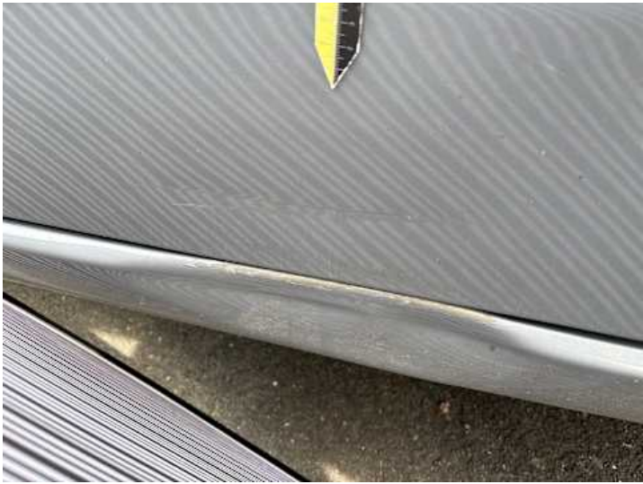
Beifahrertür (Kratzer, Verformung)
