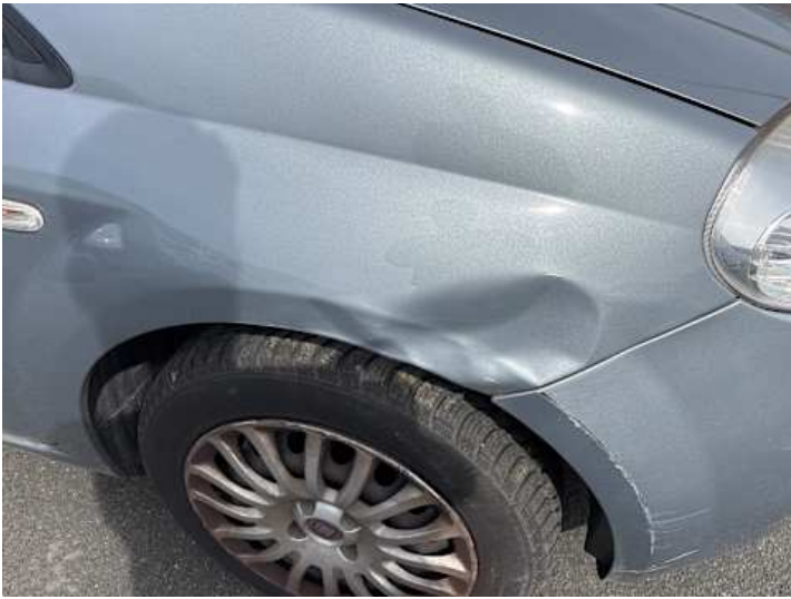
Kotflügel vorne rechts (Verformung, Lackschaden)
