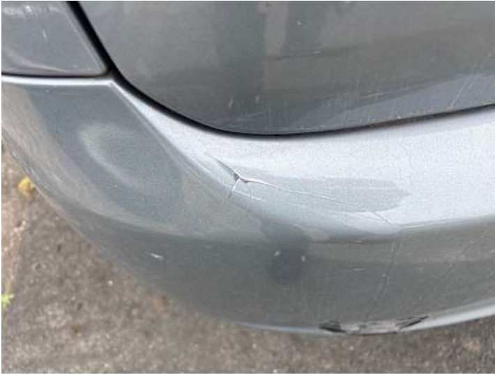
Stoßstange hinten (Kratzer, Lackschaden, Riss/Bruch)
