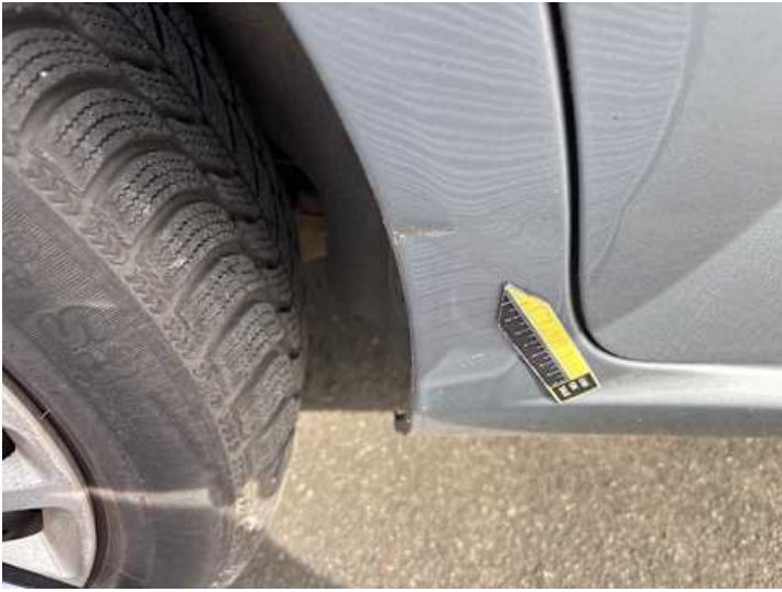
Seitenteil hinten rechts (Delle, Kratzer)
