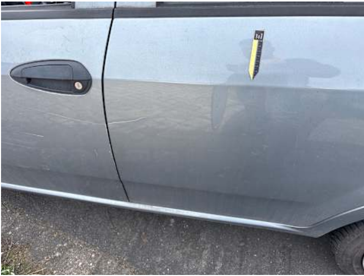
Türe hinten links (Delle, Verformung)
