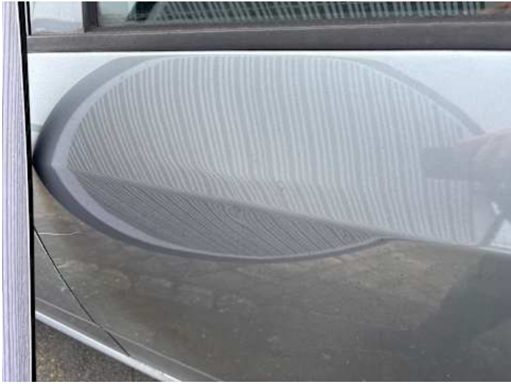
Türe hinten links (Delle, Verformung)
