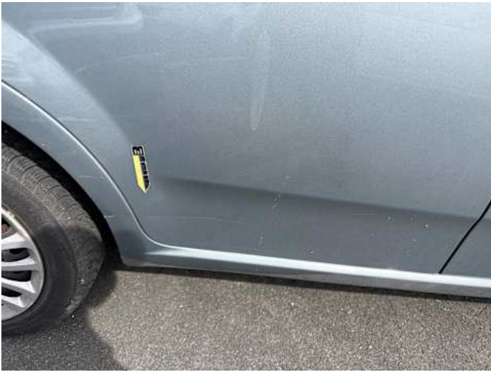
Türe hinten rechts (Verformung)
