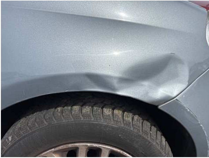
Kotflügel vorne rechts (Verformung, Lackschaden)
