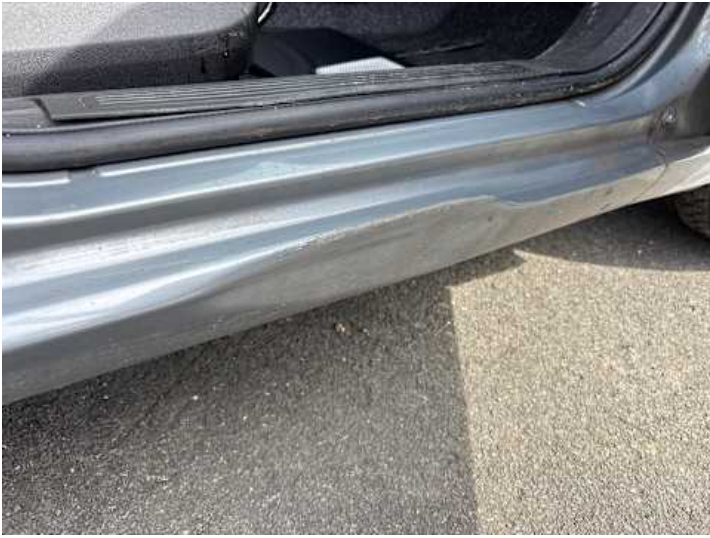
Schweller rechts (Verformung, Lackschaden)
