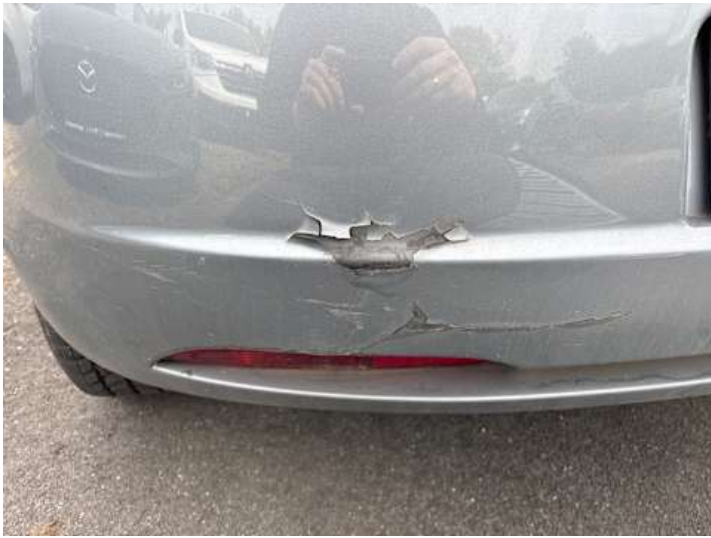
Stoßstange hinten (Kratzer, Lackschaden, Riss/Bruch)
