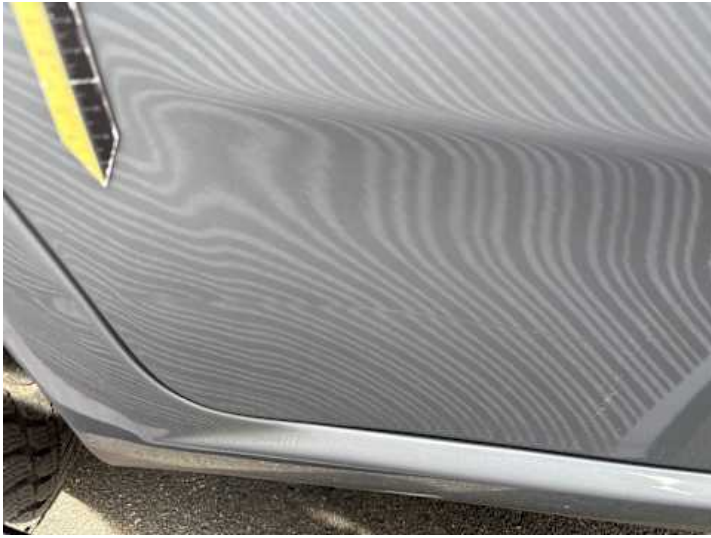
Türe hinten rechts (Verformung)
