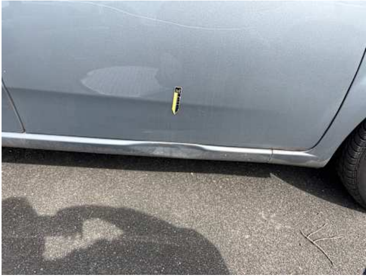
Beifahrertür (Kratzer, Verformung)
