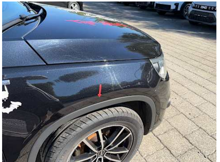
Kotflügel vorne rechts (Anderer Schaden, Kratzer, Lackschaden): Beklebung
