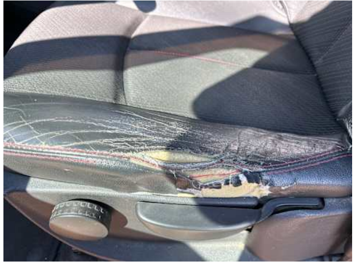
Innenraum (Verschleiß, Riss/Bruch)
