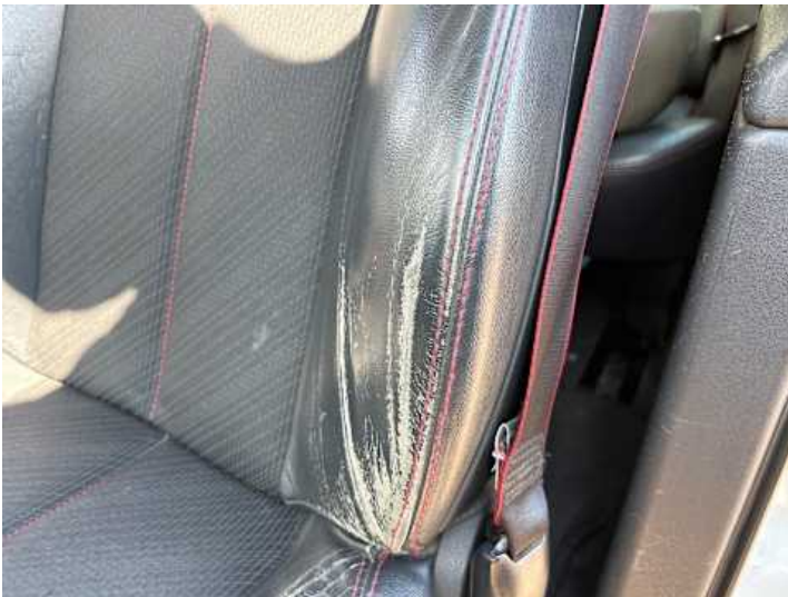
Innenraum (Verschleiß, Riss/Bruch)
