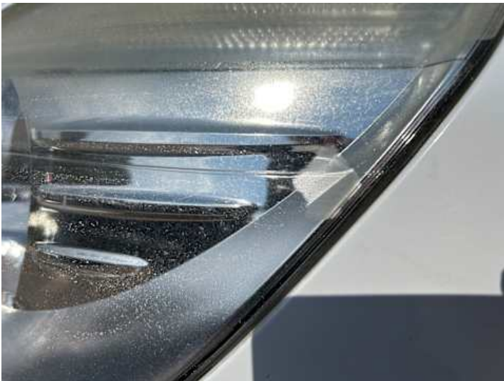
Scheinwerfer (links) (Riss/Bruch)
