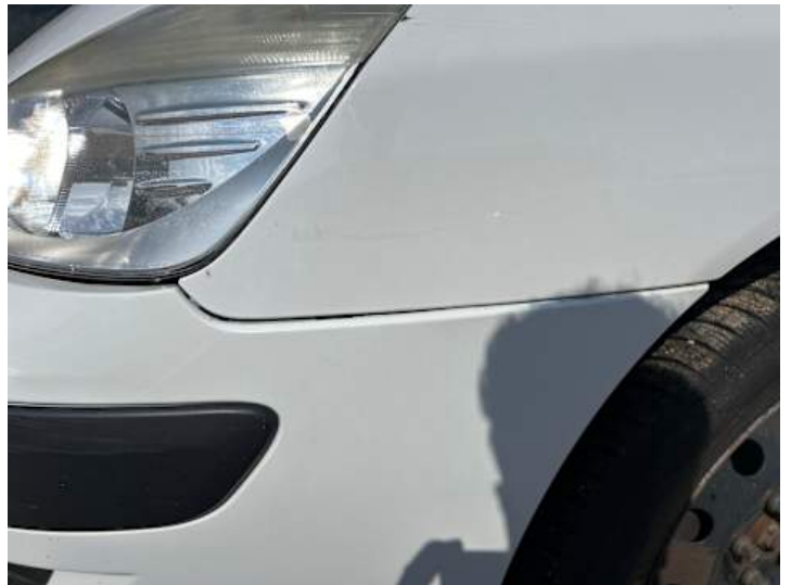
Stoßstange vorne (Spaltmaße ungenau)
