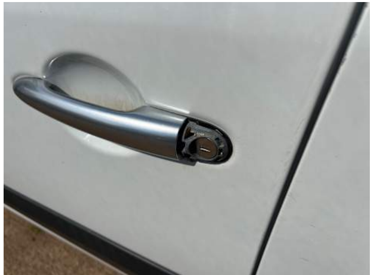
Fahrtür (Anderer Schaden): Abdeckung fehlt
