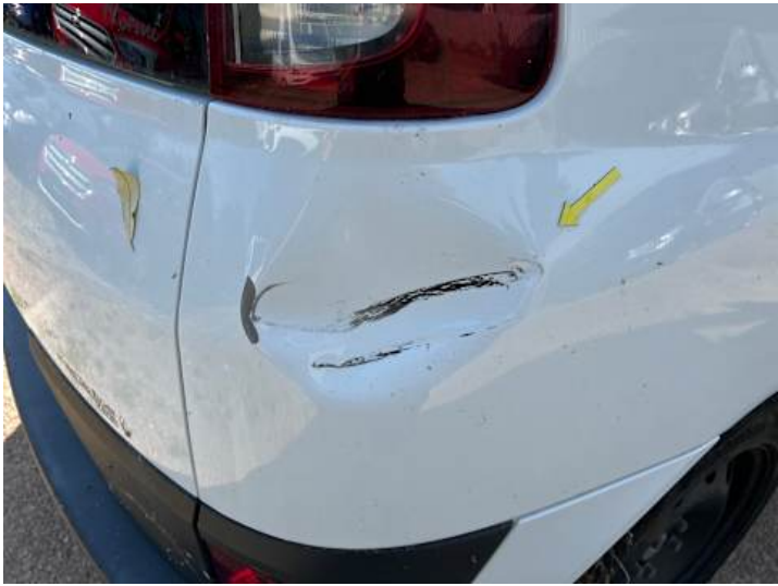
Seitenteil hinten rechts (Kratzer, Verformung)
