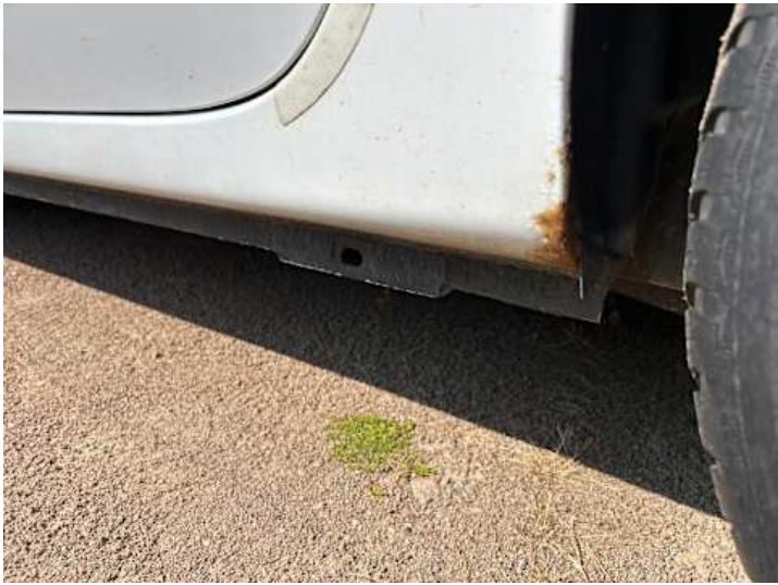
Schweller links (Rost)
