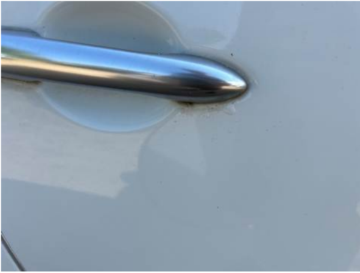
Türe hinten rechts (Rost)
