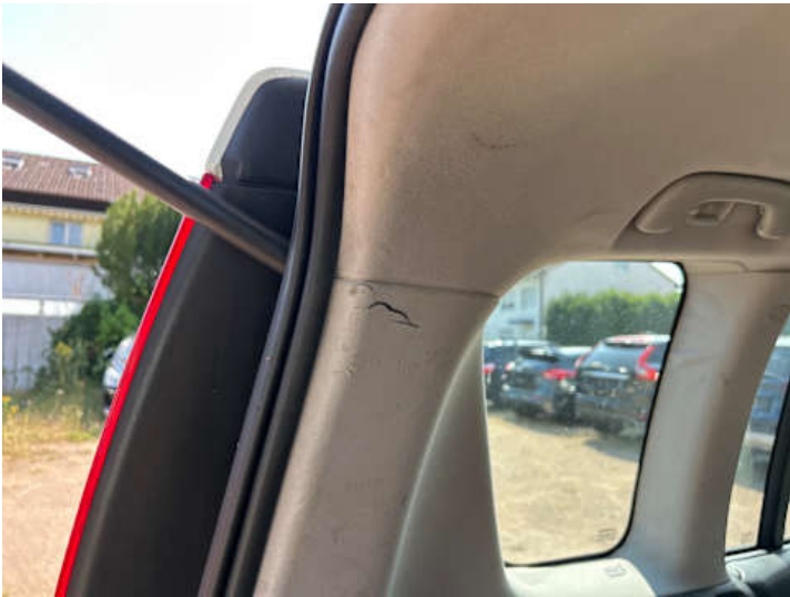
Innenraum (Verschmutzung, Kratzer)
