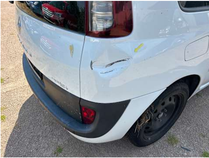
Seitenteil hinten rechts (Kratzer, Verformung)
