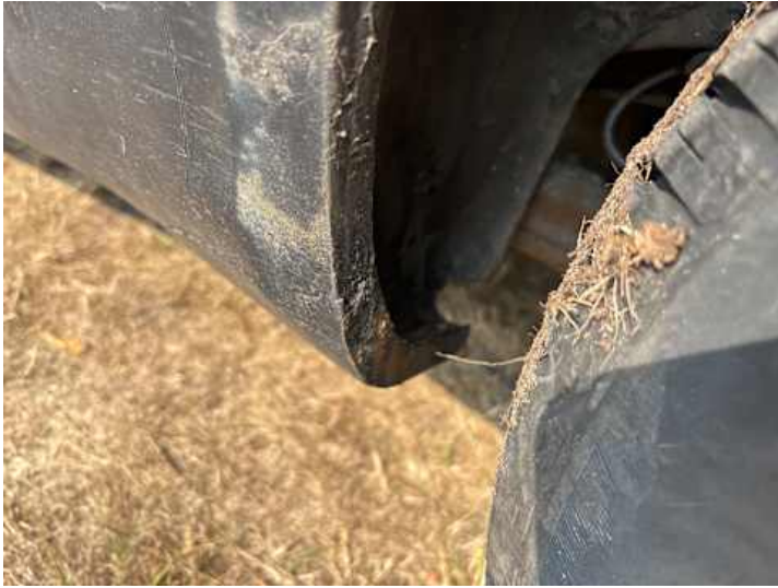
Schweller links (Rost)
