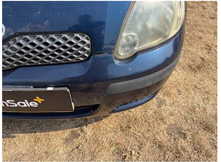
Stoßstange vorne (Unsachgemäß instand gesetzt)
