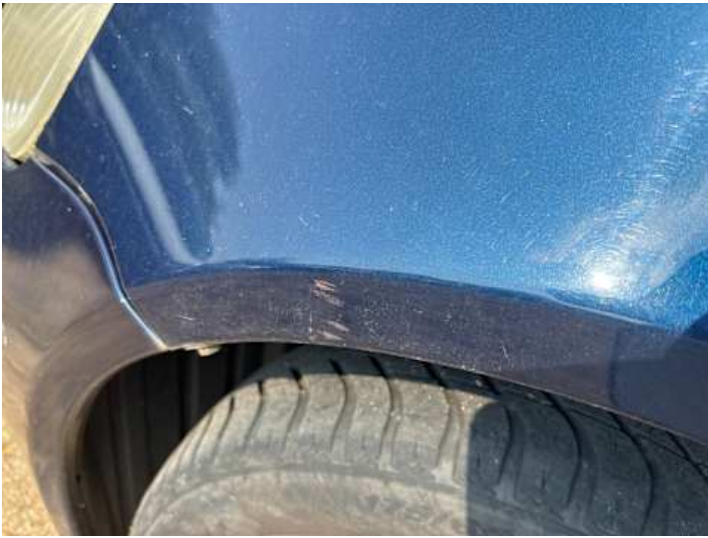
Kotflügel vorne links (Rost, Kratzer)
