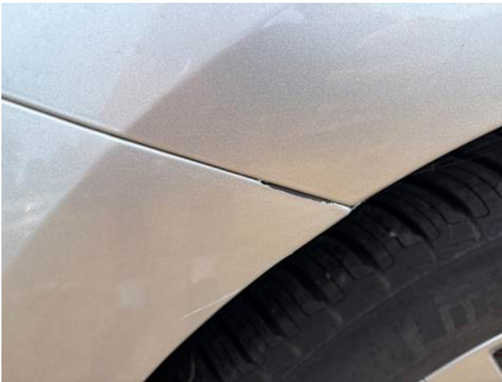
Stoßstange hinten (Kratzer, Lackschaden)
