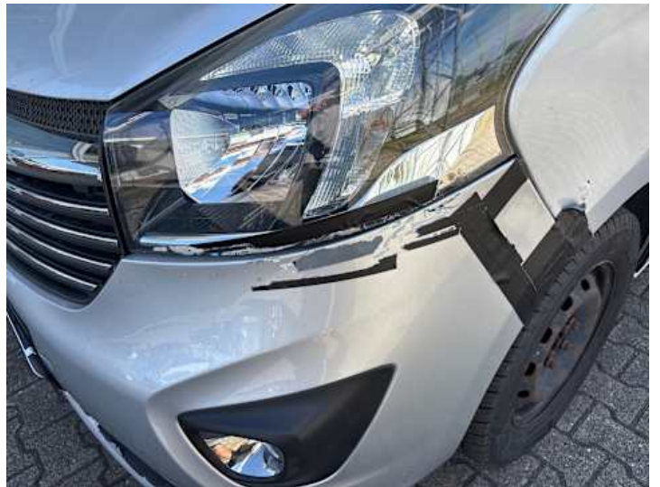
Stoßstange vorne (Unsachgemäß instand gesetzt)
