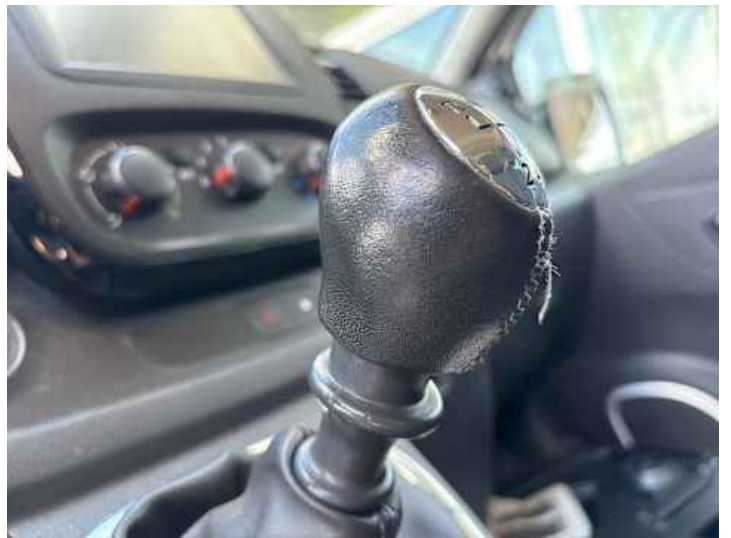
Innenraum (Verschmutzung, Verschleiß)
