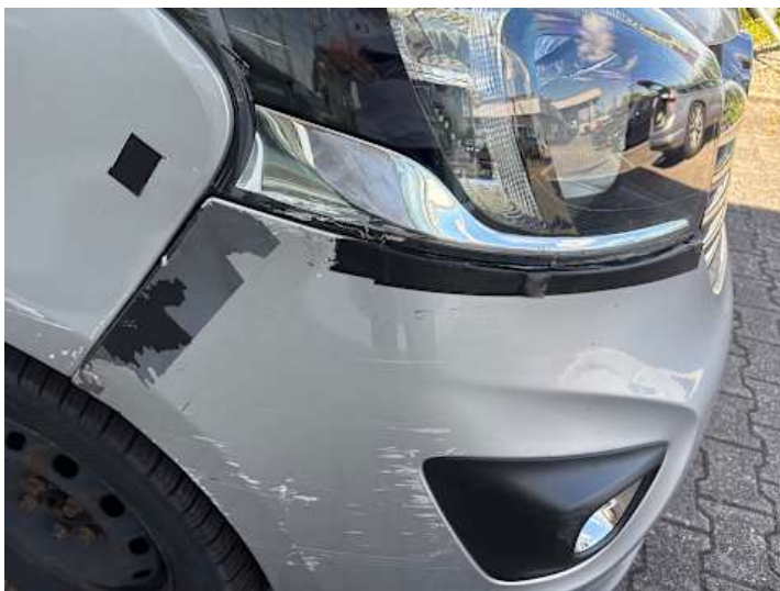
Stoßstange vorne (Unsachgemäß instand gesetzt)
