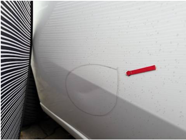
Türe hinten rechts (Lackschaden, Verformung)
