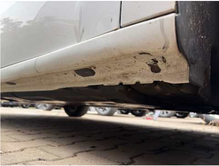
Schweller rechts (Verformung)
