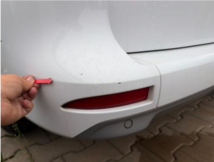
Stoßstange hinten (Lackschaden)
