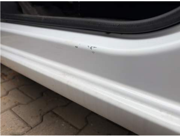
Schweller links (Lackschaden)
