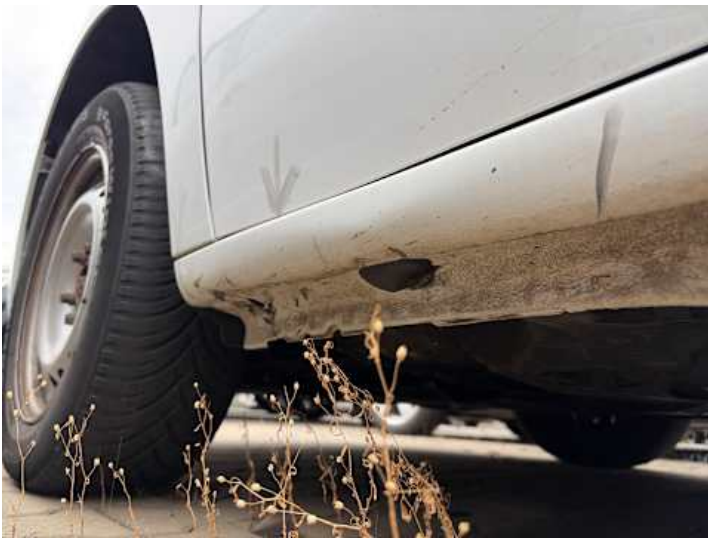
Schweller links (Verformung)
