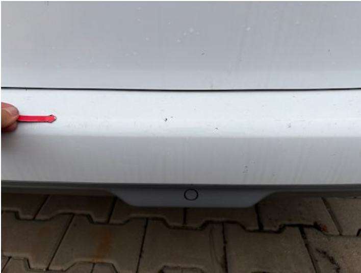
Stoßstange hinten (Lackschaden)
