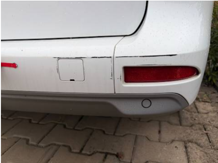
Stoßstange hinten (Lackschaden)
