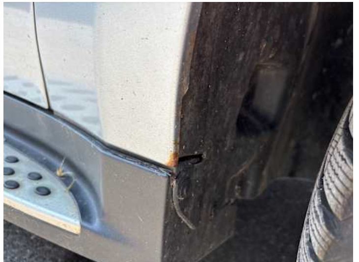
Kotflügel vorne rechts (Rost)
