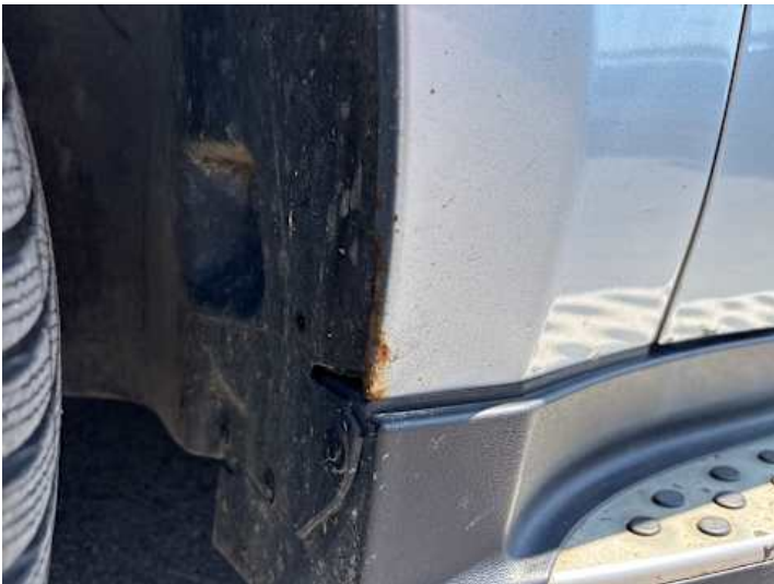
Kotflügel vorne links (Rost)
