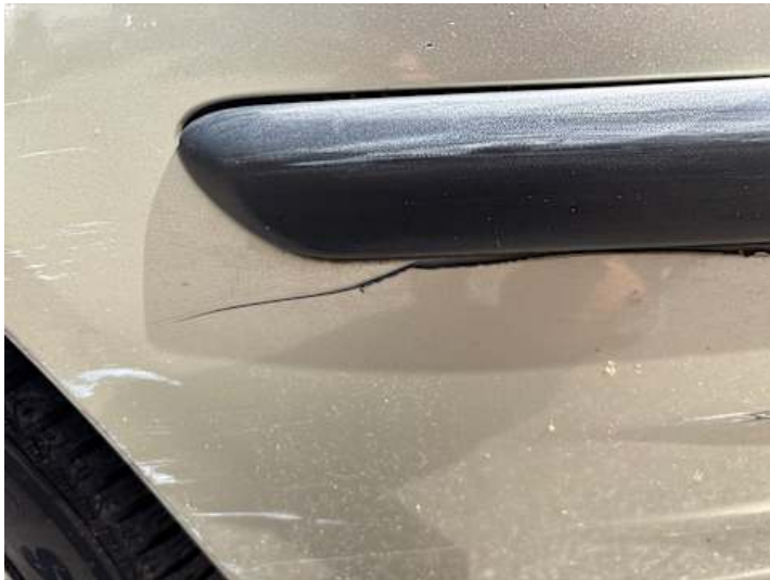
Stoßstange vorne (Unsachgemäß instand gesetzt, Kratzer)
