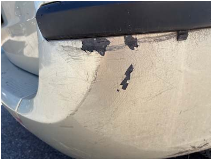
Stoßstange hinten (Lackschaden, Spaltmaße ungenau)
