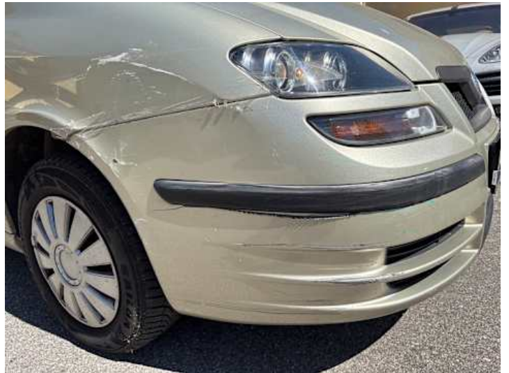
Stoßstange vorne (Unsachgemäß instand gesetzt, Kratzer)
