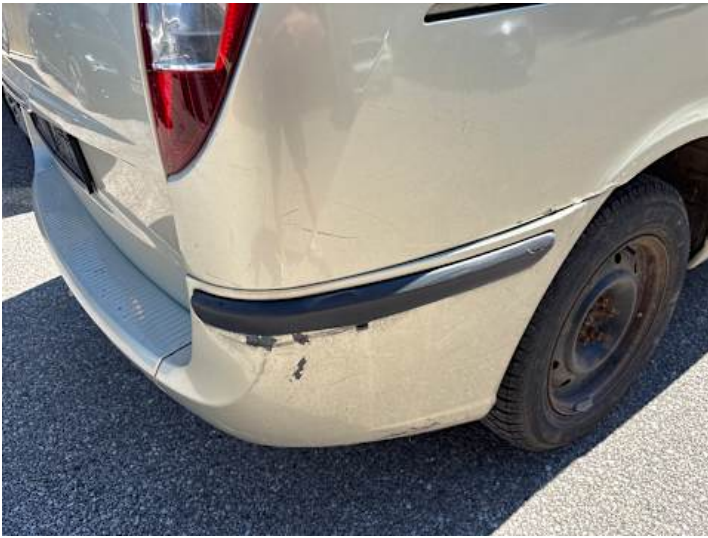
Stoßstange hinten (Lackschaden, Spaltmaße ungenau)
