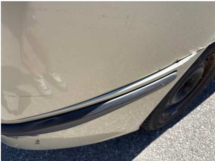
Stoßstange hinten (Lackschaden, Spaltmaße ungenau)
