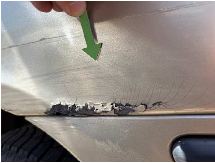
Seitenteil hinten links (Lackschaden)
