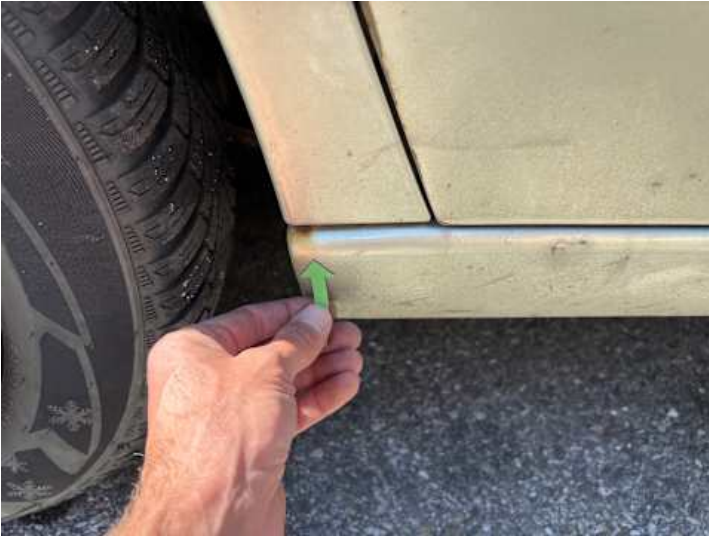
Schweller links (Rost)
