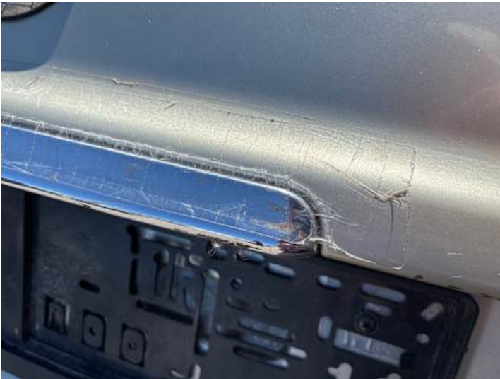
Heckklappe (Unsachgemäß instand gesetzt)
