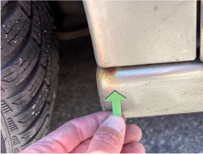
Schweller links (Rost)
