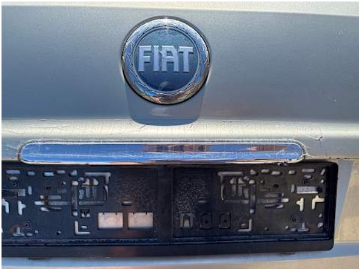
Heckklappe (Unsachgemäß instand gesetzt)
