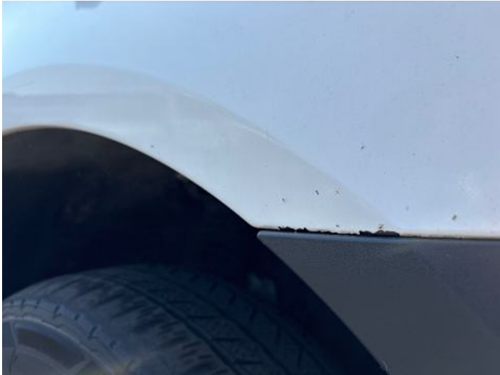
Kotflügel vorne rechts (Lackschaden, Rost)
