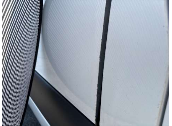
Türe hinten rechts (Lackschaden)
