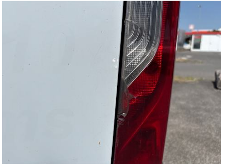
Rücklicht (rechts) (Riss/Bruch)
