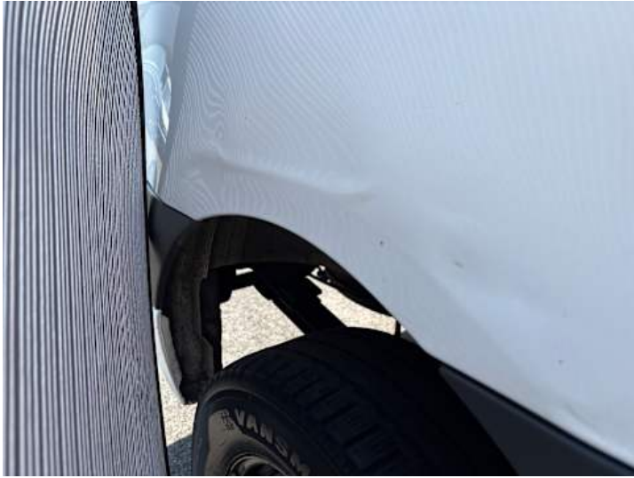
Seitenteil hinten rechts (Verformung, Lackschaden)
