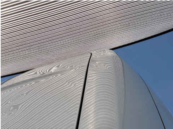
Seitenteil hinten rechts (Verformung)
