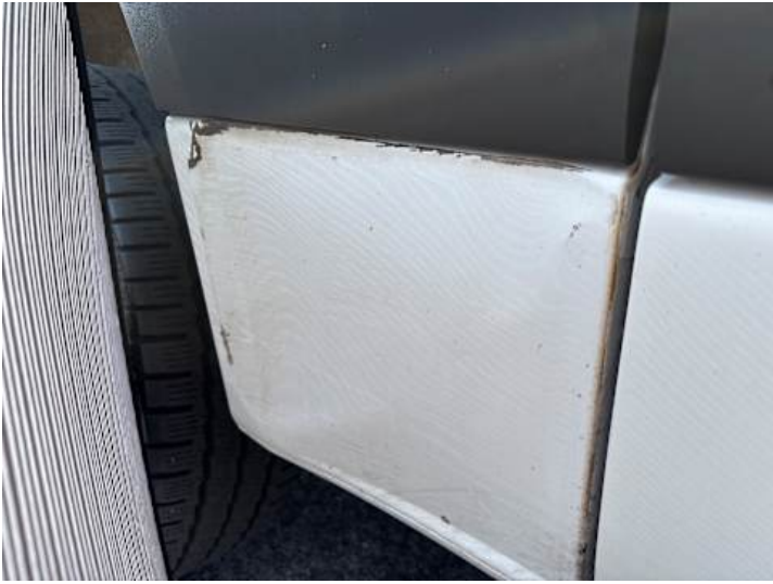
Seitenteil hinten rechts (Verformung, Lackschaden)
