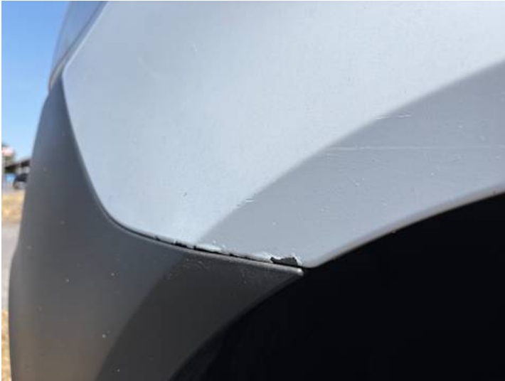
Kotflügel vorne links (Lackschaden, Rost)
