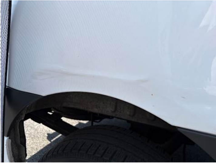
Seitenteil hinten rechts (Verformung, Lackschaden)
