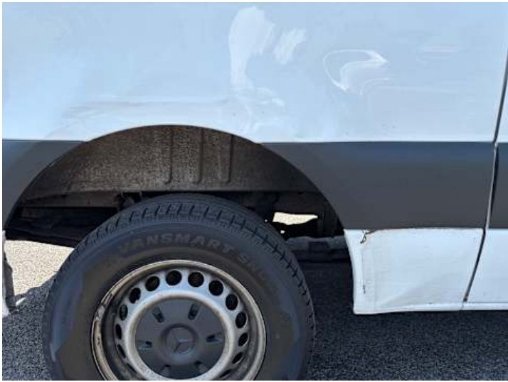
Seitenteil hinten rechts (Verformung, Lackschaden)
