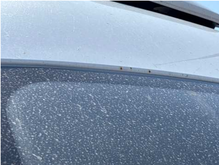
Dach (Rost, Steinschlag)
