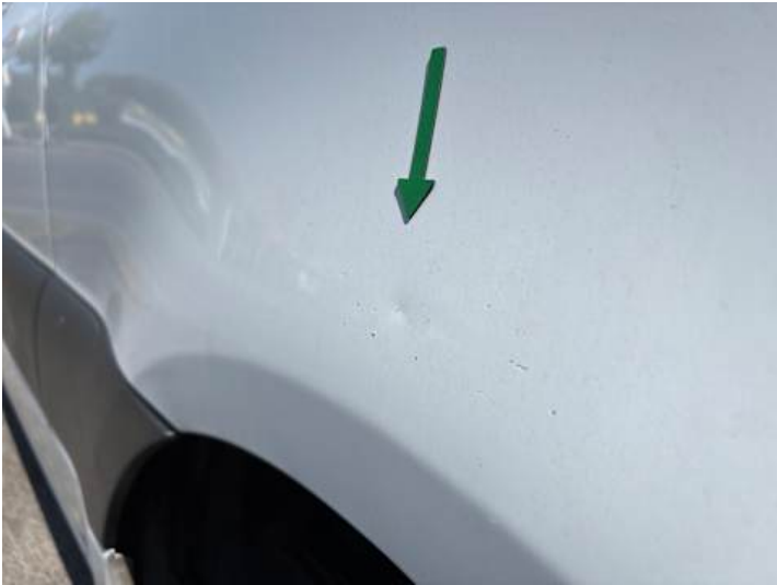
Seitenteil hinten links (Lackschaden)
