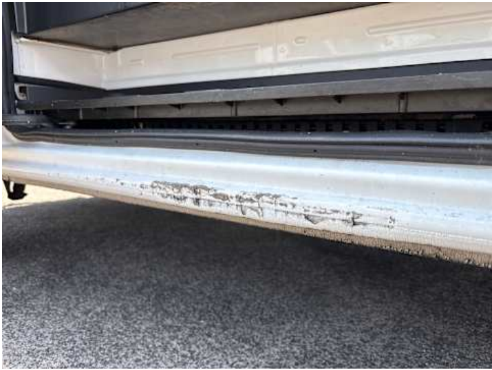
Schweller rechts (Verformung, Lackschaden)
