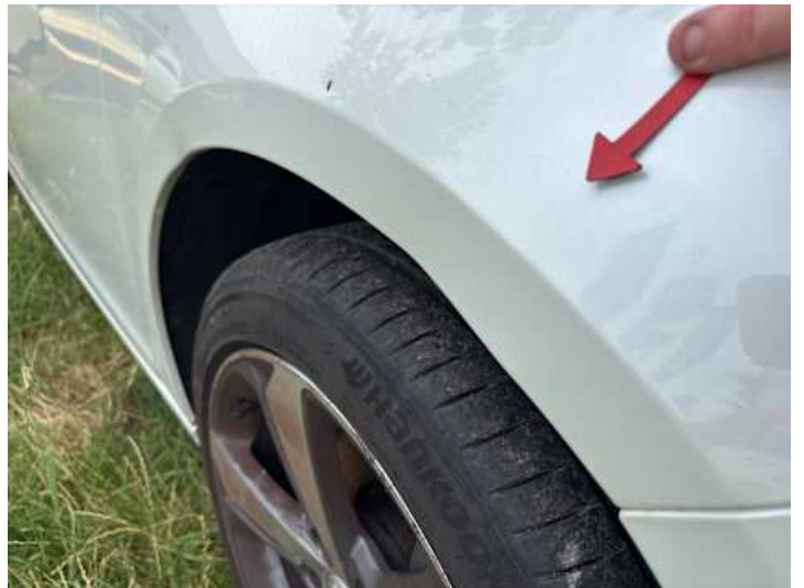
Kotflügel vorne rechts (Verformung)
