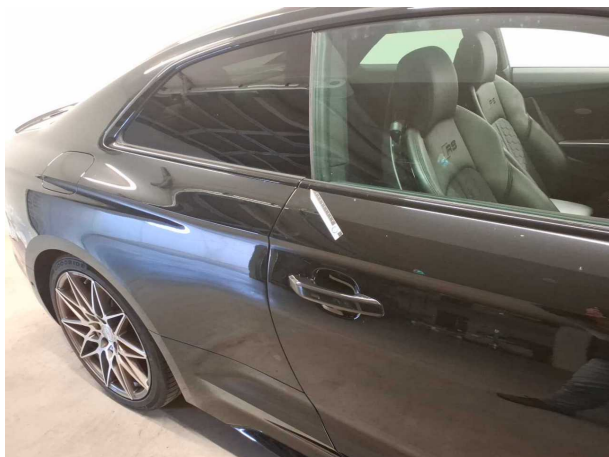
Beschädigung 1: Tür vorn rechts: Schachtleiste außen - Kratzer - erneuern
