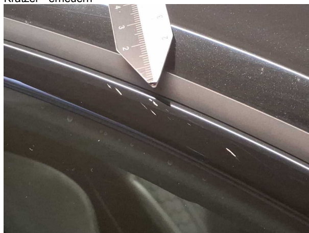
Beschädigung 2: Seitenwand rechts: Zierleiste - Kratzer - erneuern
