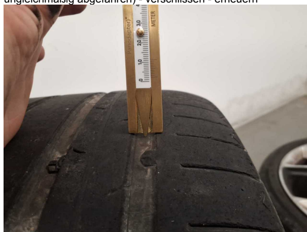
Beschädigung 6: Rad/Reifen: Reifensatz komplett (Reifen ungleichmäßig abgefahren) - verschlissen - erneuern
