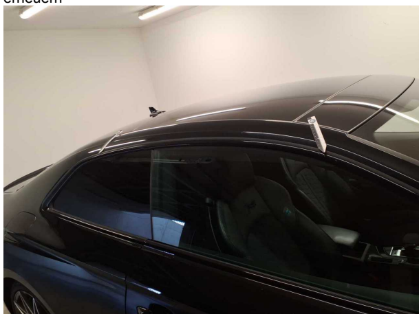
Beschädigung 2: Seitenwand rechts: Zierleiste - Kratzer - erneuern
