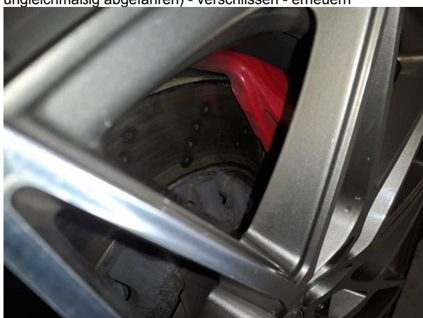
Gebrauchsspur 4: Bremsanlage: Bremsscheiben und Beläge vor... (lt. Sichtprüfung kurz vor Verschleißgrenze, durch wkst.prüfen) - l...
