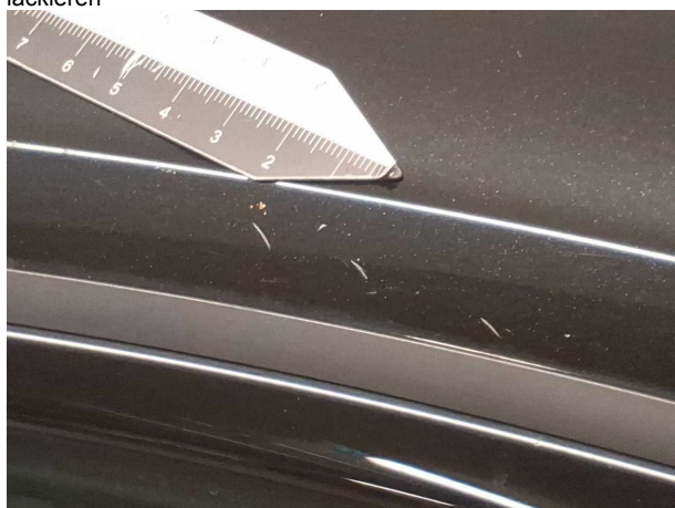
Beschädigung 4: Fahrzeugdach: Dachholm rechts - verkratzt / verschürft - lackieren
