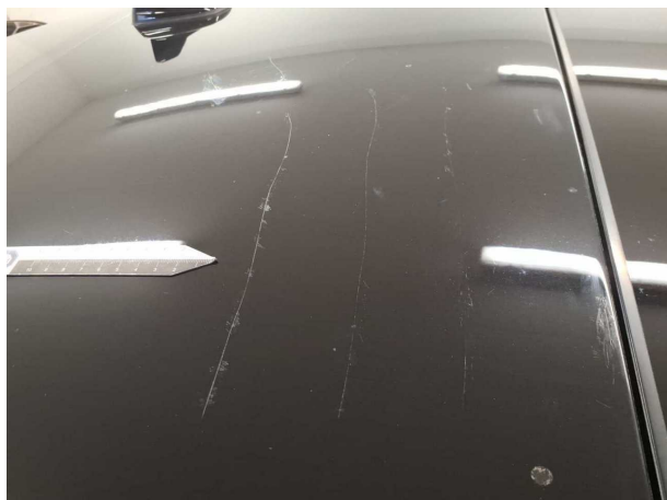
Beschädigung 3: Fahrzeugdach: Dach - verkratzt / verschürft - lackieren
