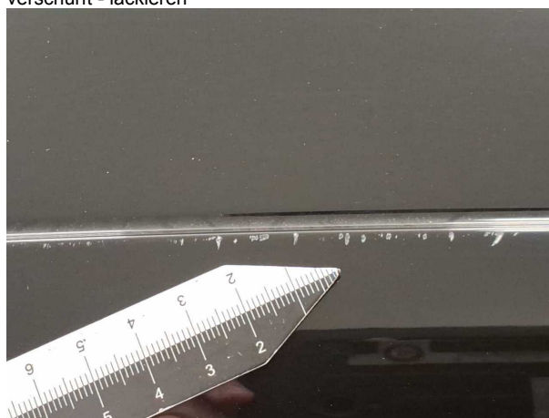
Beschädigung 4: Fahrzeugdach: Dachholm rechts - verkratzt / verschürft - lackieren
