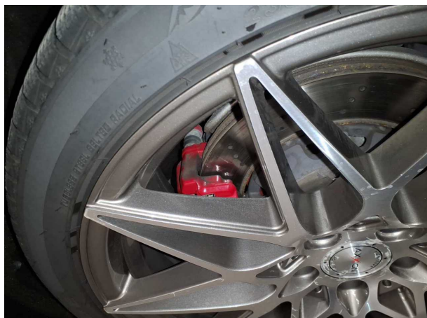
Gebrauchsspur 5: Bremsanlage: Bremsscheiben und Beläge hinten (Lt. Sichtprüfung kurz vor Verschleißgrenze, durch Vorschadenfotos
