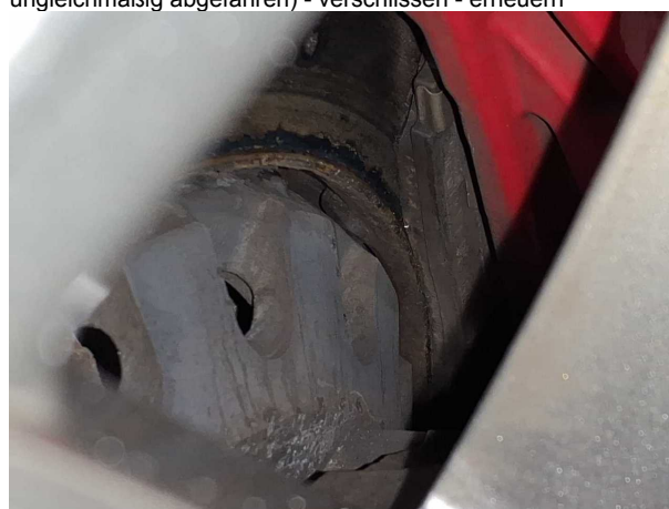
Gebrauchsspur 4: Bremsanlage: Bremsscheiben und Beläge vorn (lt. Sichtprüfung kurz vor Verschleißgrenze, durch
