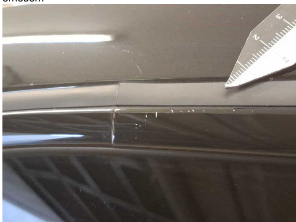
Beschädigung 2: Seitenwand rechts: Zierleiste - Kratzer - erneuern
