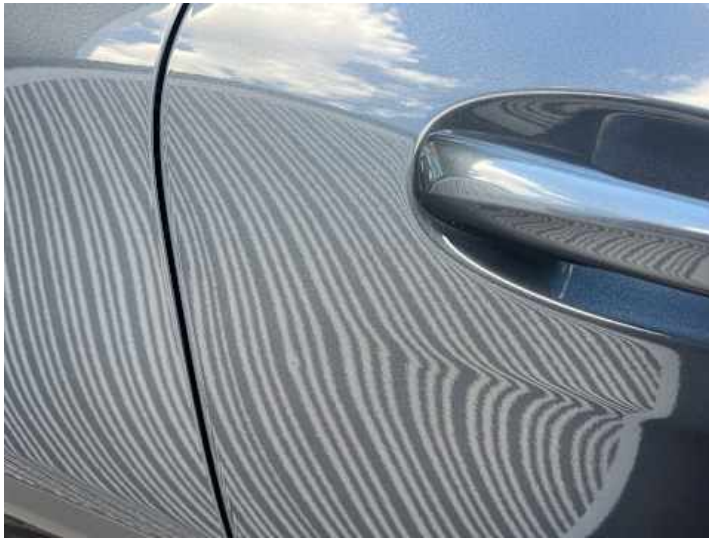
Türe hinten rechts (Delle)
