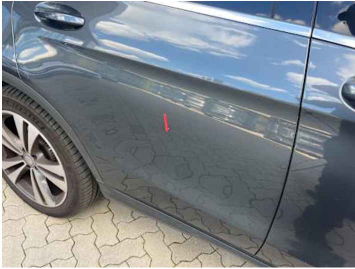
Türe hinten rechts (Delle)
