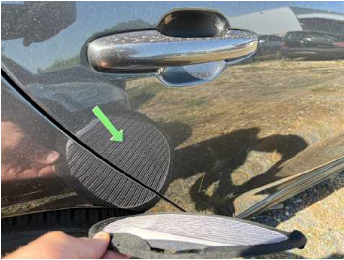
Türe hinten rechts (Delle)
