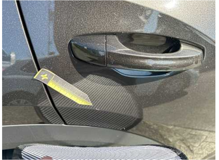
Türe hinten rechts (Delle, Kratzer)
