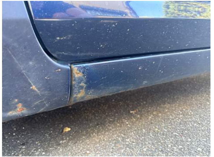
Schweller links (Rost)
