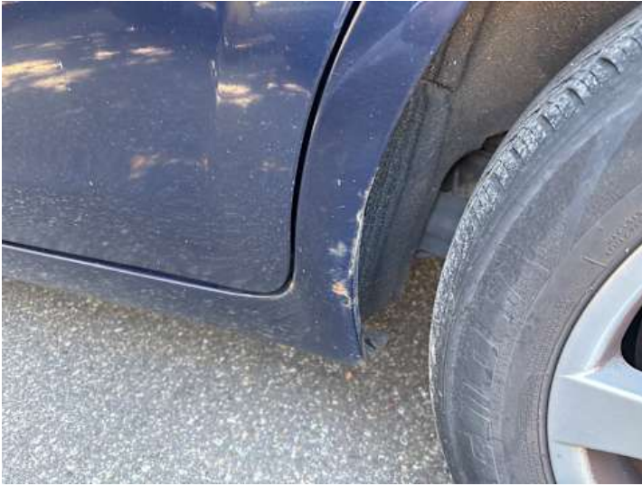
Seitenteil hinten links (Rost)
