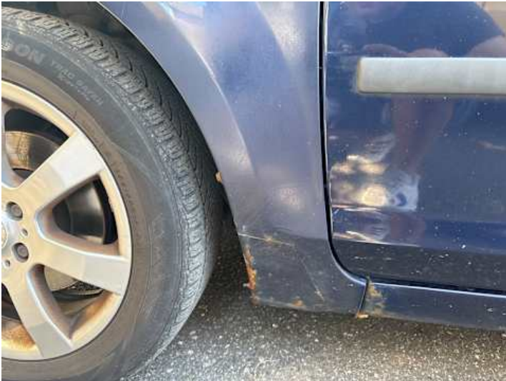
Kotflügel vorne links (Rost, Unsachgemäß instand gesetzt)
