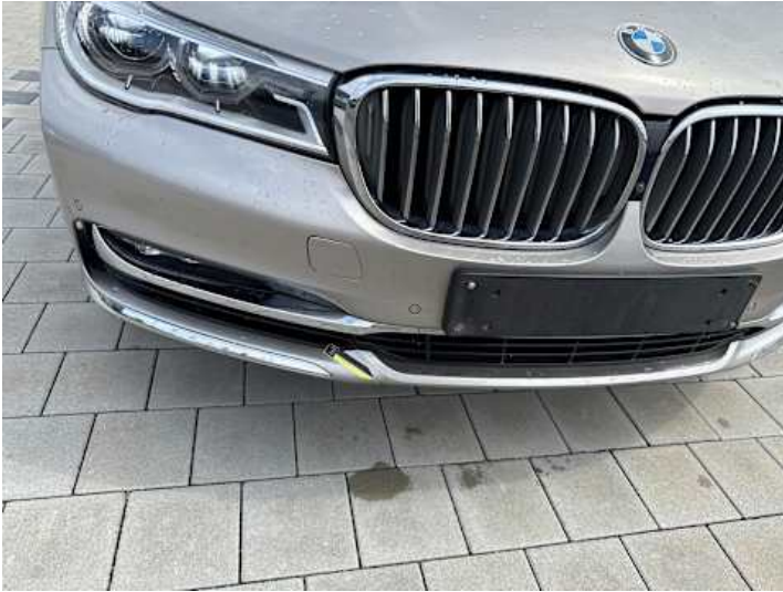
Stoßstange vorne (Riss/Bruch, Kratzer)
