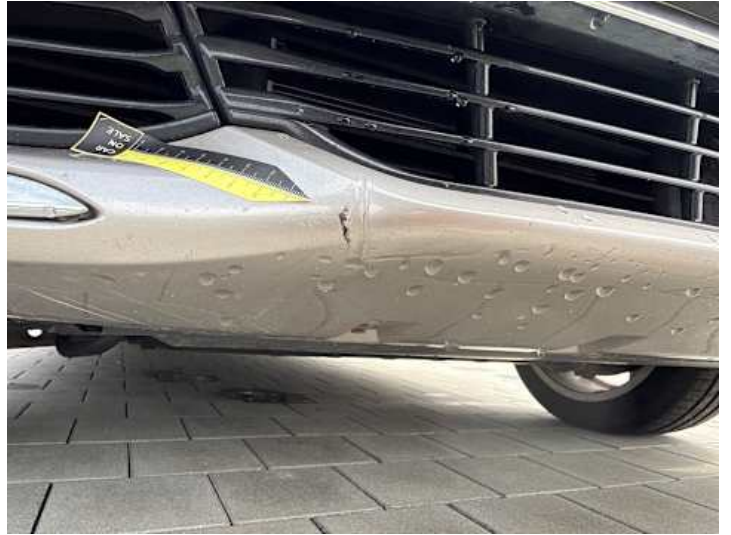
Stoßstange vorne (Riss/Bruch, Kratzer)
