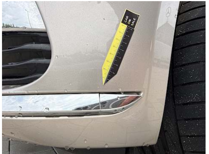
Stoßstange vorne (Riss/Bruch, Kratzer)
