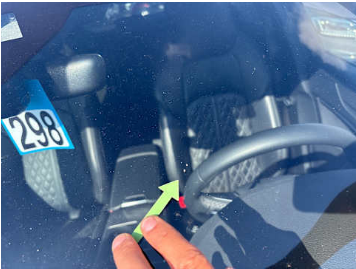
Windschutzscheibe (Anderer Schaden): Sehr viele Steinschläge
