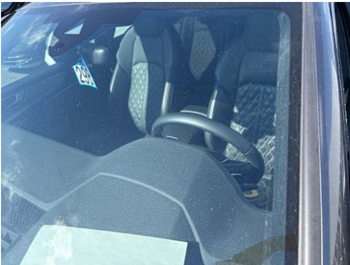
Windschutzscheibe (Anderer Schaden): Sehr viele Steinschläge
