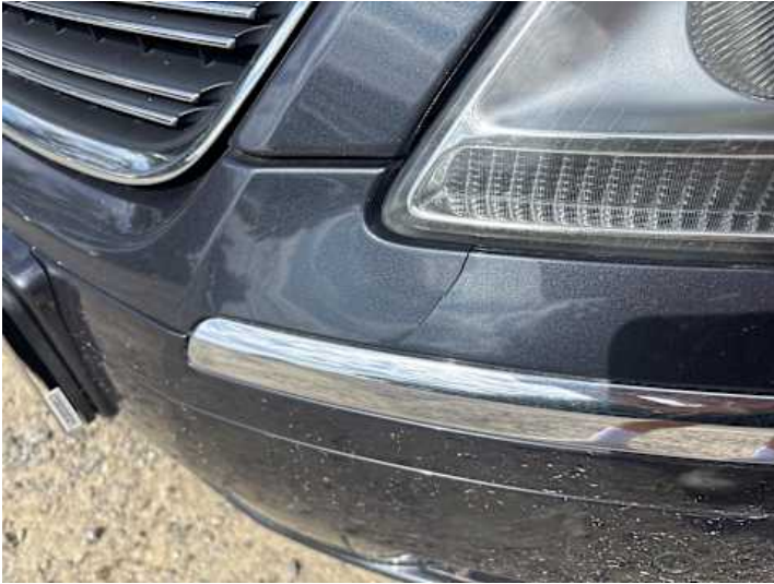
Stoßstange vorne (Riss/Bruch)
