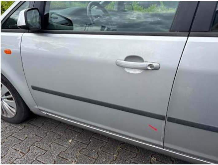
Fahrrertür (Kratzer, Lackschaden)
