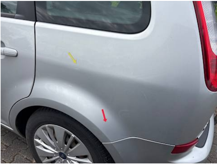
Seitenteil hinten links (Kratzer)
