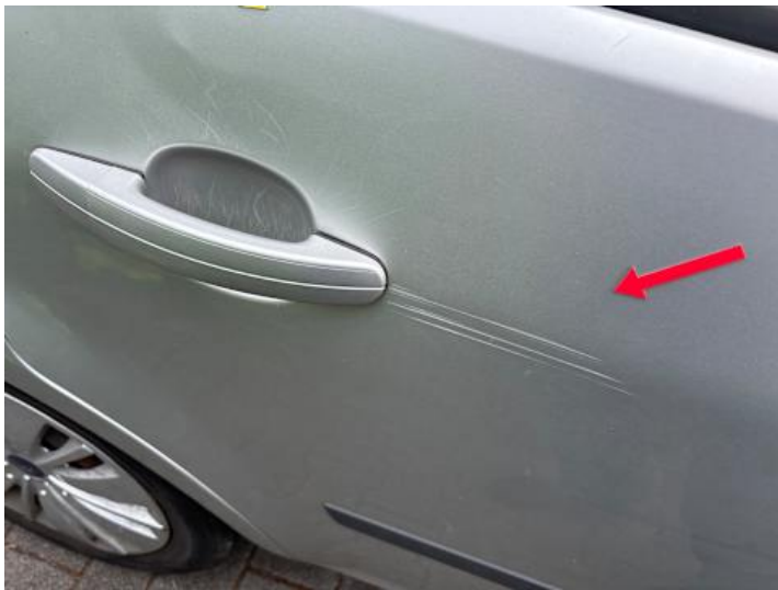
Türe hinten rechts (Kratzer, Lackschaden)
