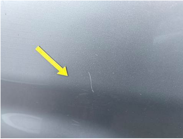
Seitenteil hinten links (Kratzer)
