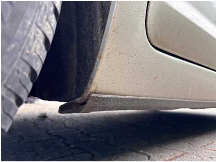
Schweller rechts (Lackschaden, Rost)
