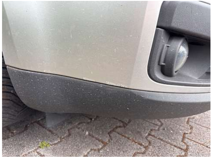
Stoßstange vorne (Kratzer, Lackschaden)
