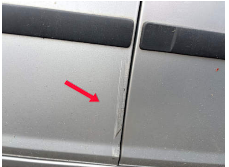
Fahrtür (Kratzer, Lackschaden)
