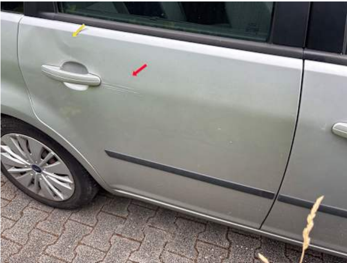
Türe hinten rechts (Kratzer, Lackschaden, Delle)
