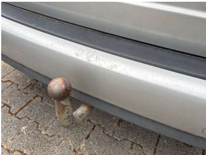
Stoßstange hinten (Kratzer, Lackschaden)
