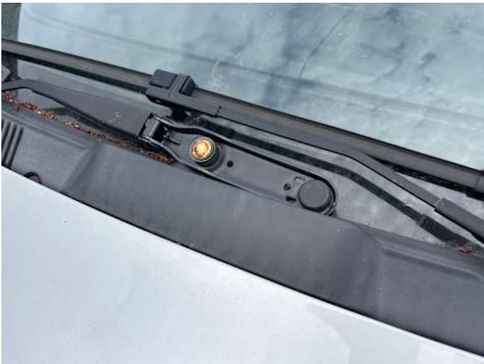
Windschutzscheibe (Anderer Schaden): Wischerarmabdeckung fehlt
