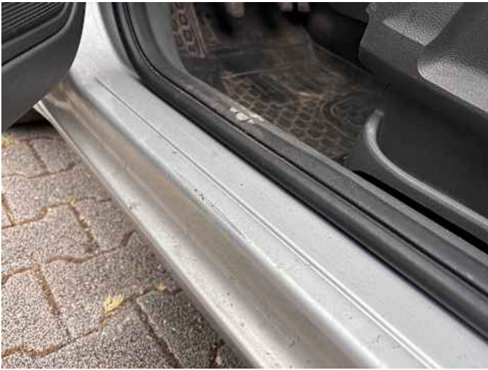
Schweller links (Kratzer, Lackschaden)
