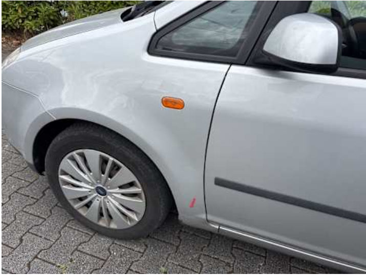
Kotflügel vorne links (Lackschaden, Rost)
