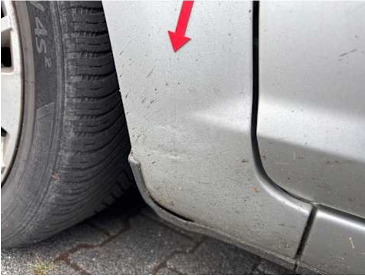
Kotflügel vorne links (Lackschaden, Rost)
