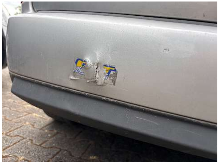
Stoßstange hinten (Kratzer, Lackschaden, Riss/Bruch)
