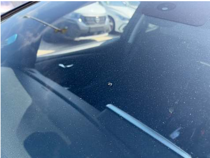
Windschutzscheibe (Steinschlag, Riss/Bruch)
