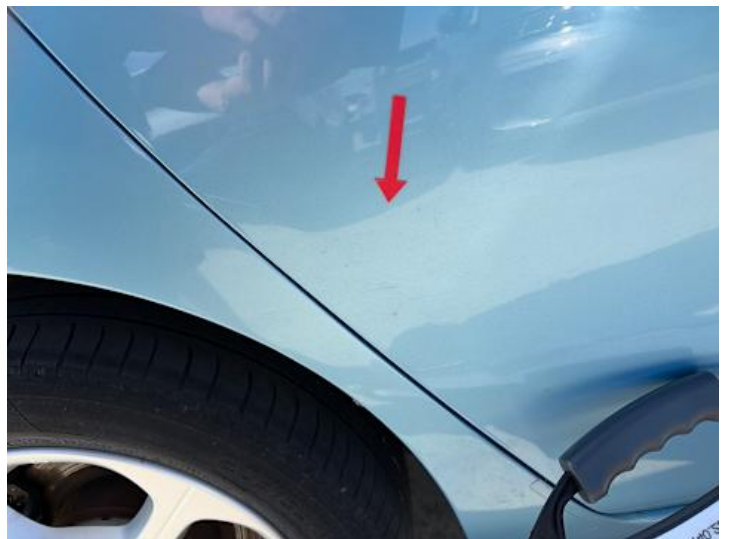
Türe hinten rechts (Kratzer, Lackschaden)
