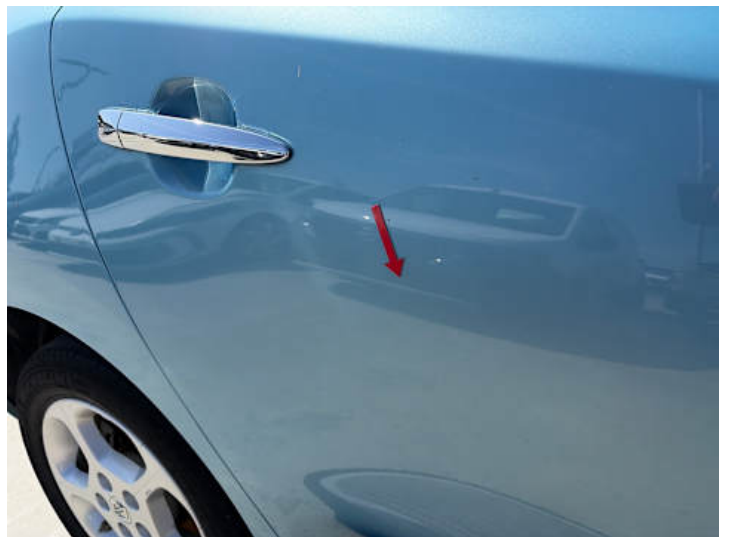
Türe hinten rechts (Kratzer, Lackschaden)
