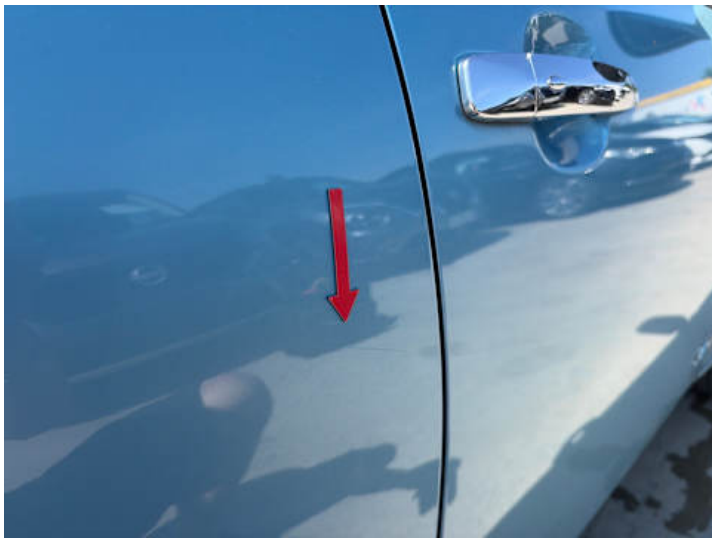
Türe hinten rechts (Kratzer, Lackschaden)
