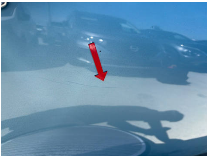
Türe hinten rechts (Kratzer, Lackschaden)
