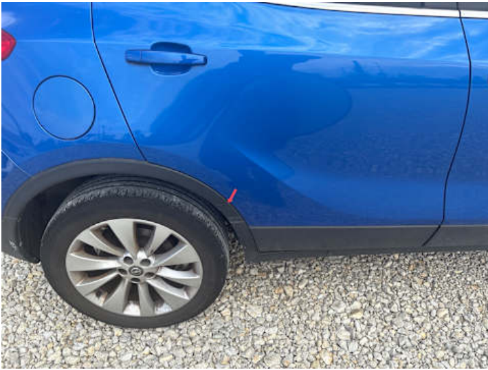
Seitenteil hinten rechts (Kratzer)
