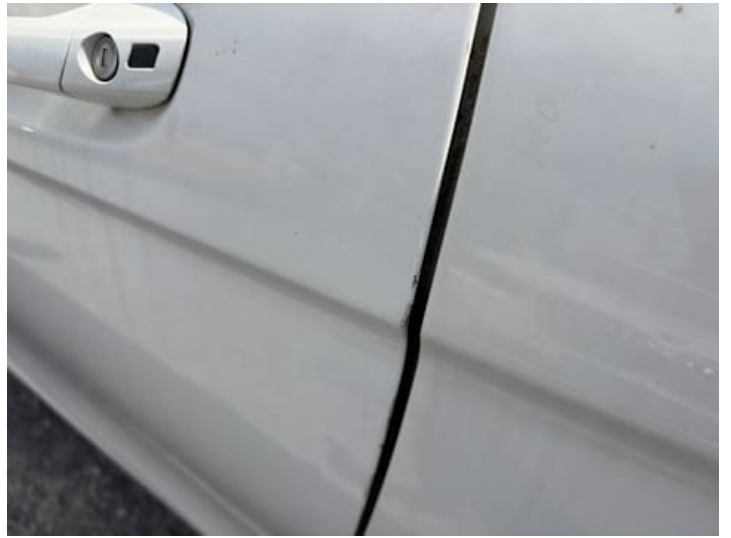
Fahrtür (Kratzer, Lackschaden, Delle)
