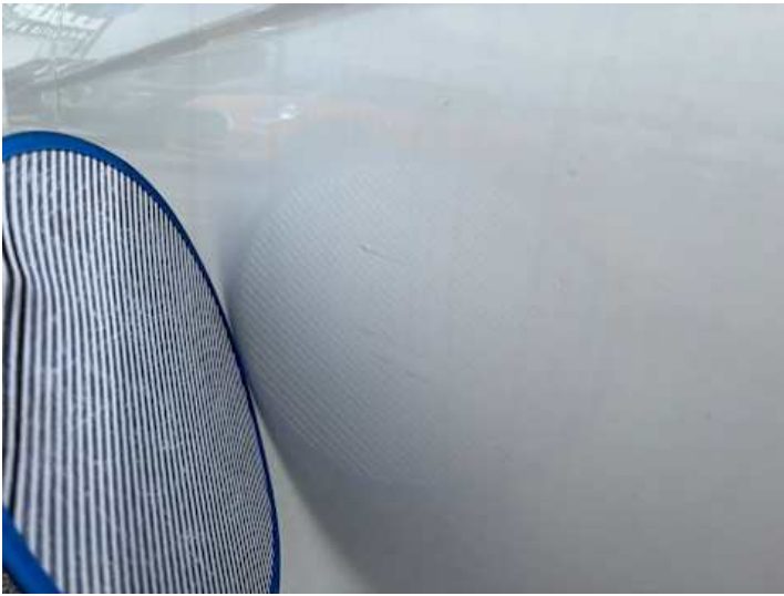
Fahrtür (Kratzer, Lackschaden, Delle)
