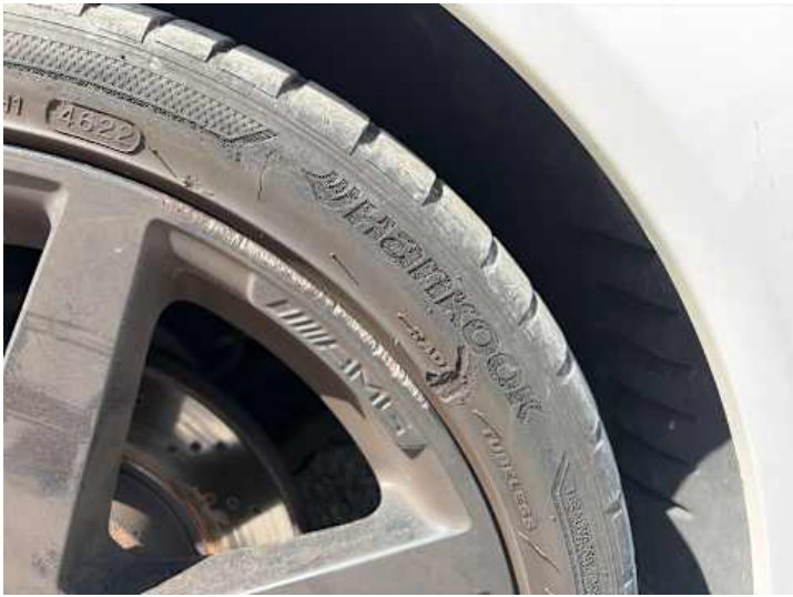
Rad (Kerben, Kratzer, Riss/Bruch)
