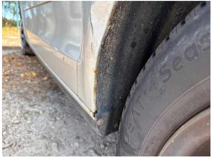
Kotflügel vorne rechts (Rost)
