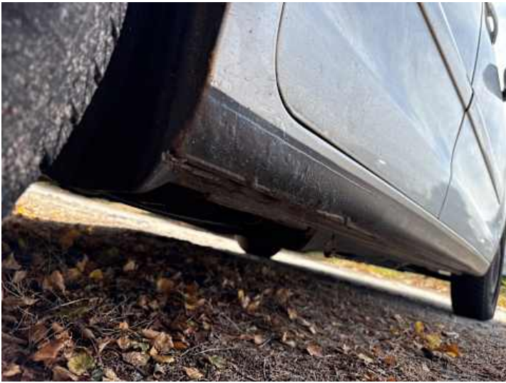
Schweller rechts (Rost, Unsachgemäß instand gesetzt)
