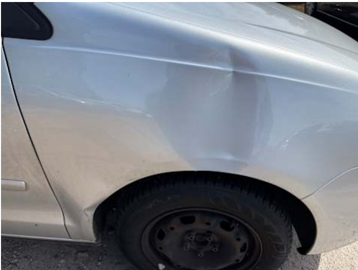
Kotflügel vorne rechts (Verformung, Lackschaden)
