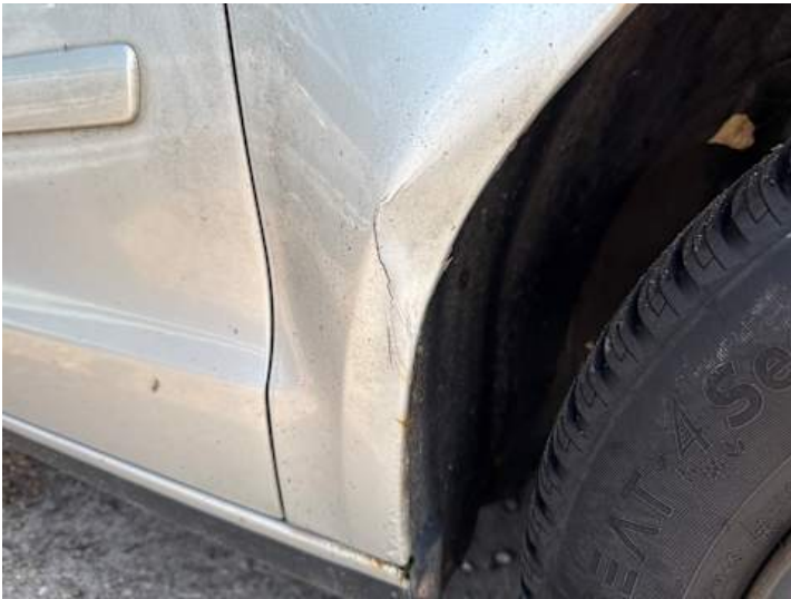
Kotflügel vorne rechts (Verformung, Lackschaden)
