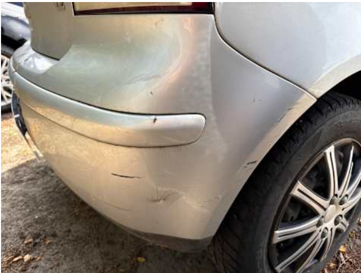
Stoßstange hinten (Lackschaden)
