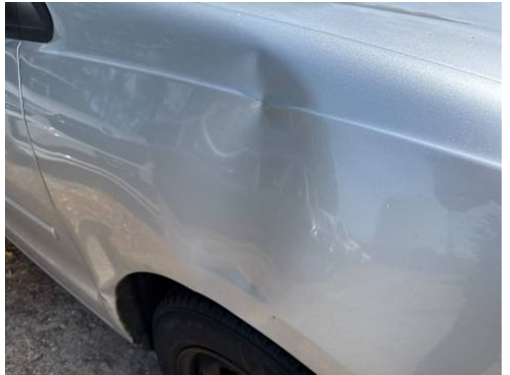
Kotflügel vorne rechts (Verformung, Lackschaden)
