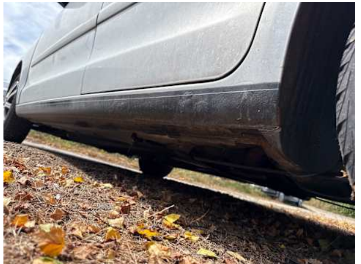
Schweller links (Rost, Unsachgemäß instand gesetzt)
