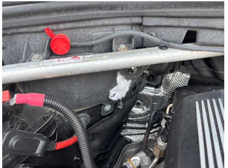
Motorhaube (Anderer Schaden): Dämmmatte beschädigt
