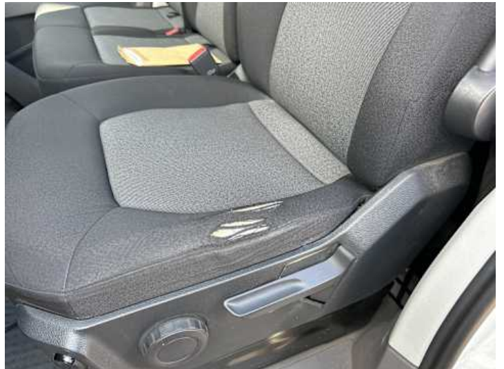
Innenraum (Verschleiß, Diverse Schäden)
