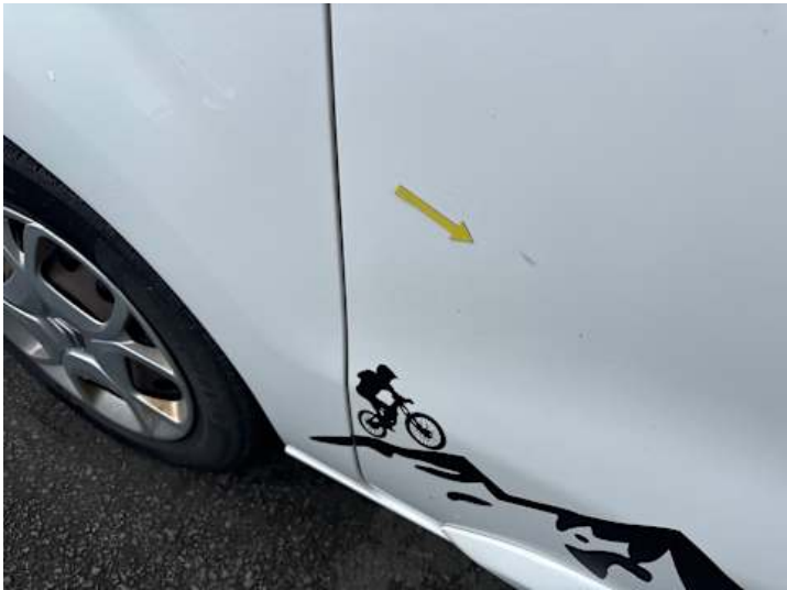
Türe hinten rechts (Kratzer)
