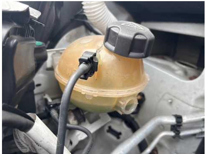
Motorhaube (Anderer Schaden): Kühlmittel stand unter Minimum
