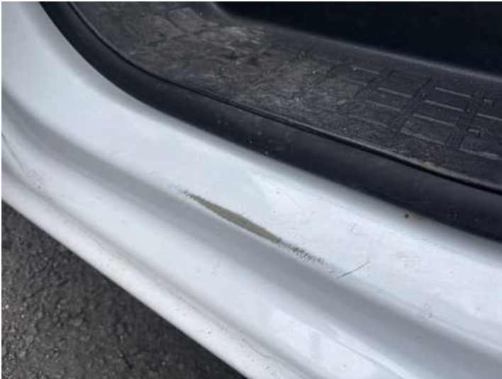
Schweller links (Lackschaden)
