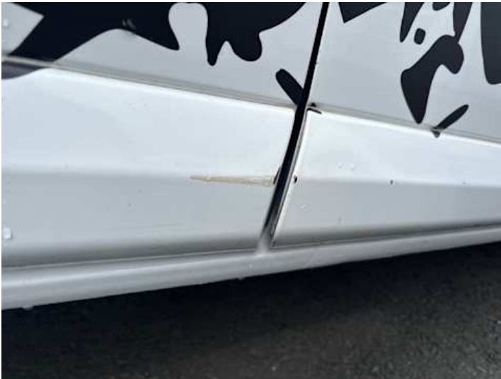
Türe hinten rechts (Lackschaden)
