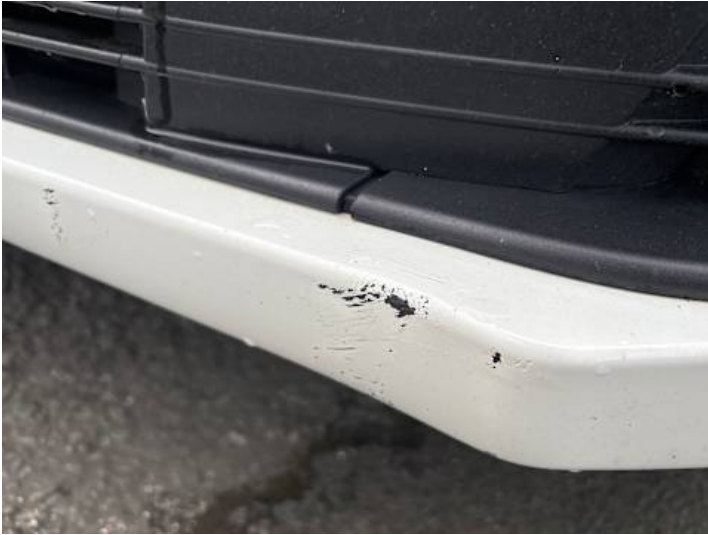
Stoßstange vorne (Riss/Bruch)
