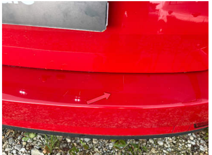
Stoßstange hinten (Kratzer)
