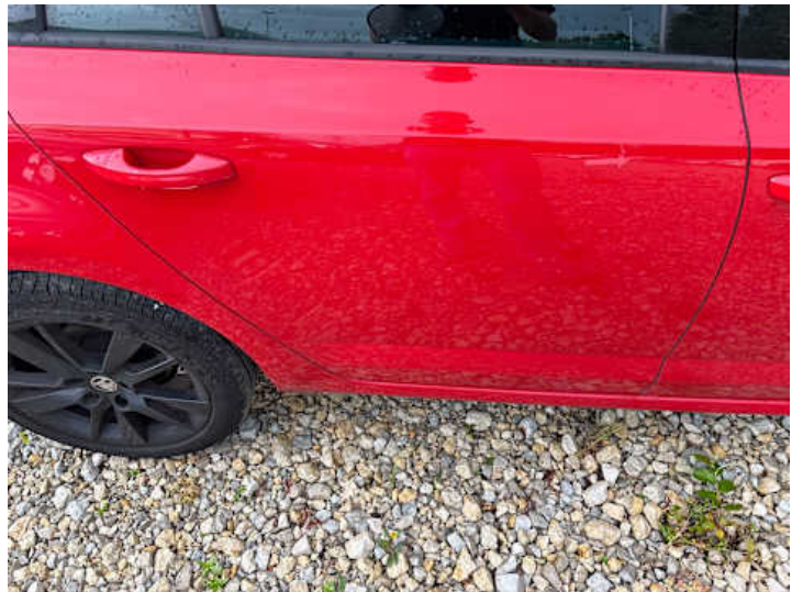
Türe hinten rechts (Delle, Kratzer)
