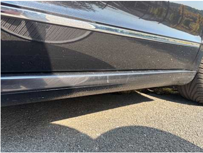
Schweller rechts (Kratzer)
