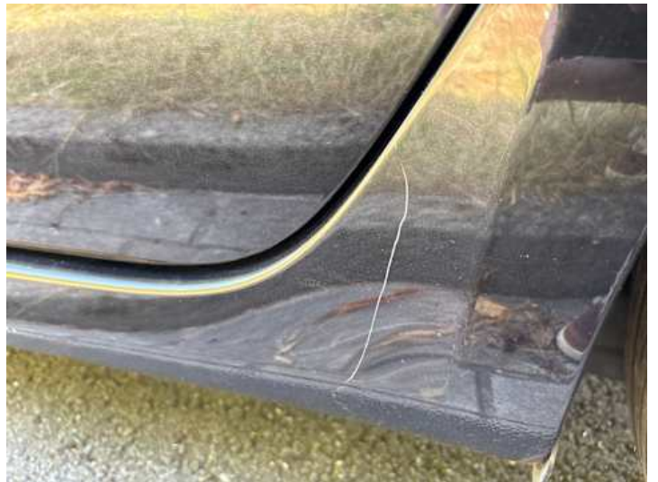
Schweller links (Kratzer)
