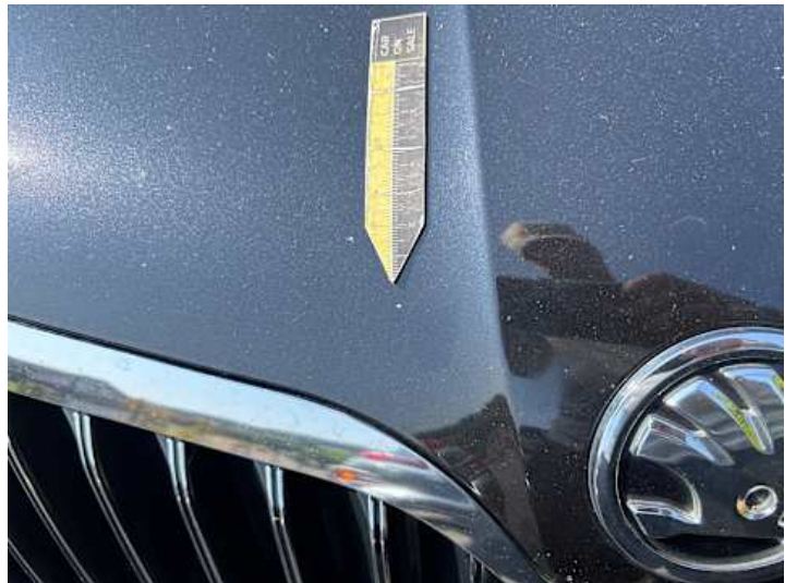
Motorhaube (Steinschlag, Delle)
