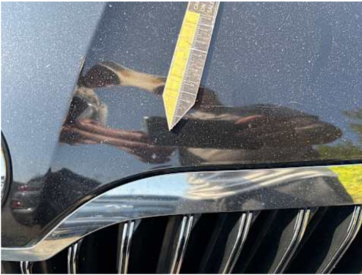
Motorhaube (Steinschlag, Delle)
