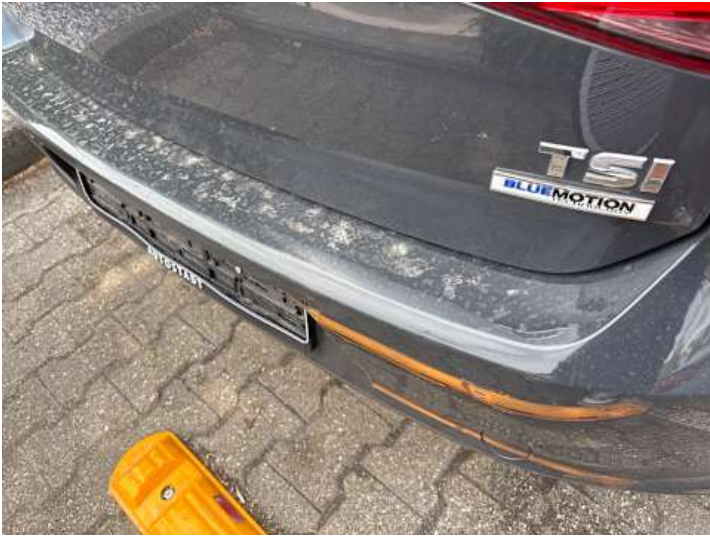
Stoßstange hinten (Riss/Bruch)
