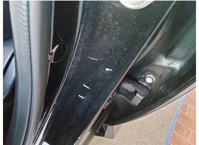
Türeinstieg VL Smart - Repair Kratzer
