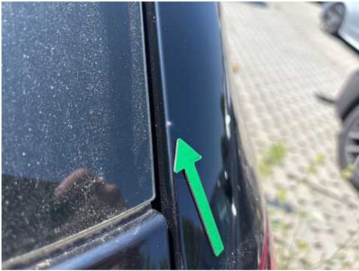
Seitenteil hinten rechts (Rost)
