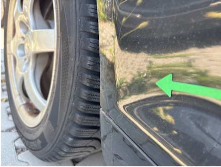
Seitenteil hinten rechts (Rost)
