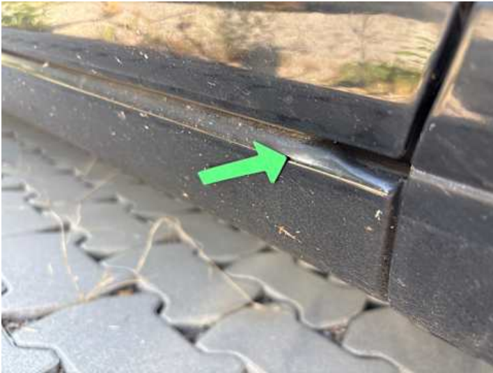
Schweller rechts (Verformung)
