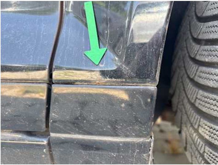
Kotflügel vorne rechts (Rost)
