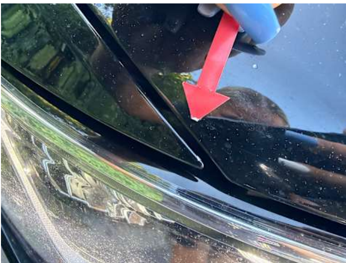
Kotflügel vorne rechts (Steinschlag)
