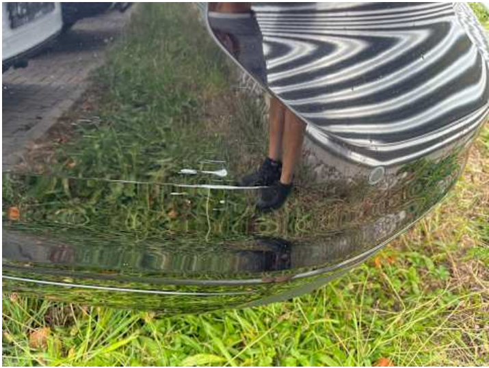
Stoßstange hinten (Kratzer, Lackschaden)
