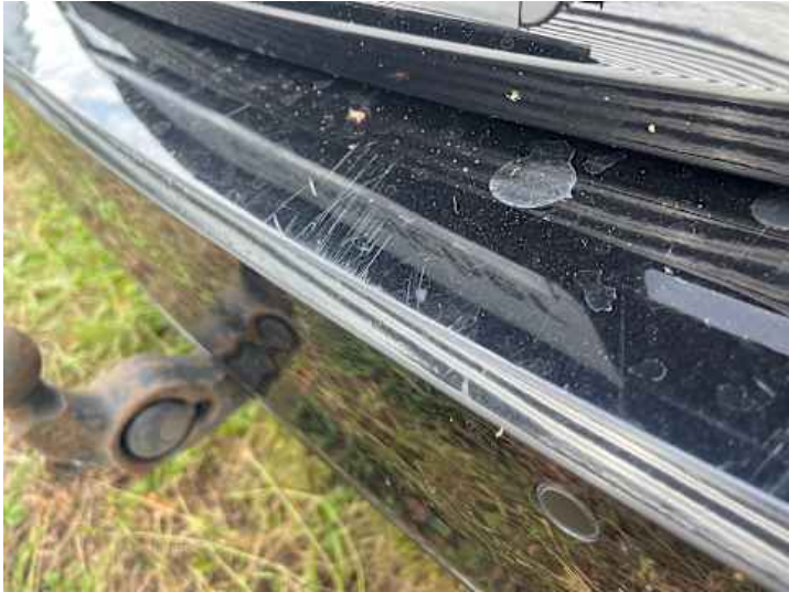
Stoßstange hinten (Kratzer, Lackschaden)
