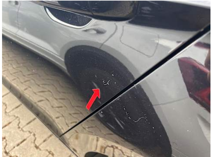
Türe hinten links (Lackschaden)
