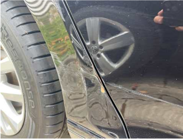
Seitenteil hinten rechts (Rost, Lackschaden, Verformung)
