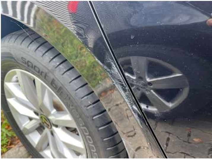
Seitenteil hinten rechts (Rost, Lackschaden, Verformung)
