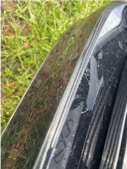
Stoßstange hinten (Kratzer, Lackschaden)
