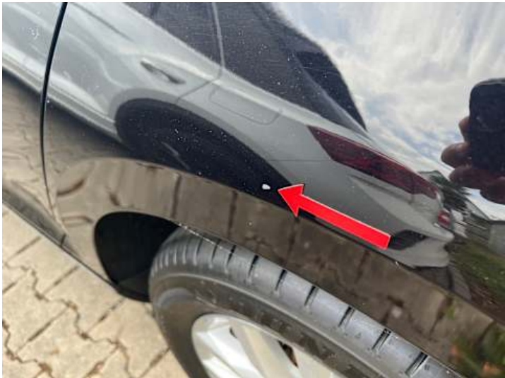
Seitenteil hinten links (Lackschaden)
