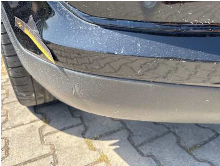
Stoßstange vorne (Kratzer, Lackschaden)
