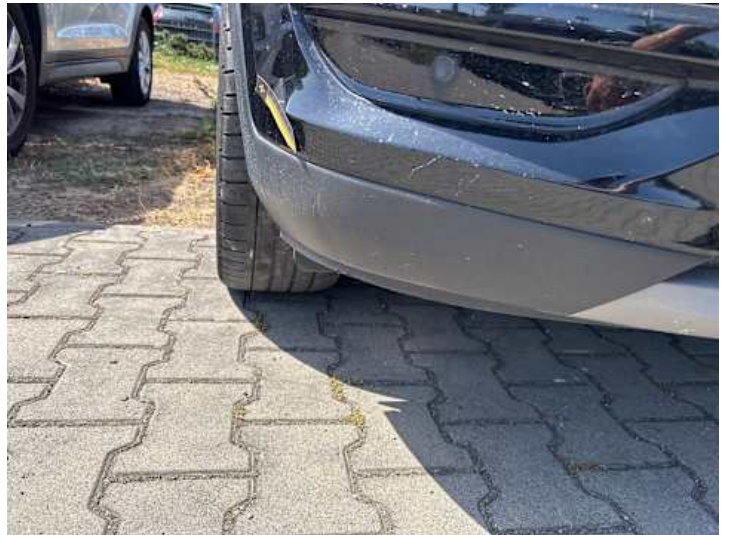
Stoßstange vorne (Kratzer, Lackschaden)
