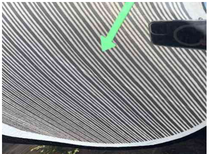
Türe hinten rechts (Delle)
