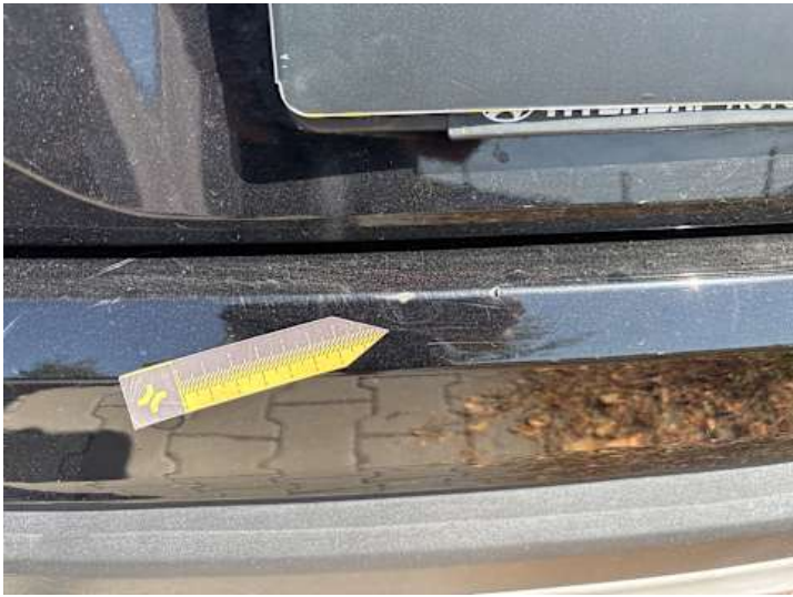
Stoßstange hinten (Lackschaden)
