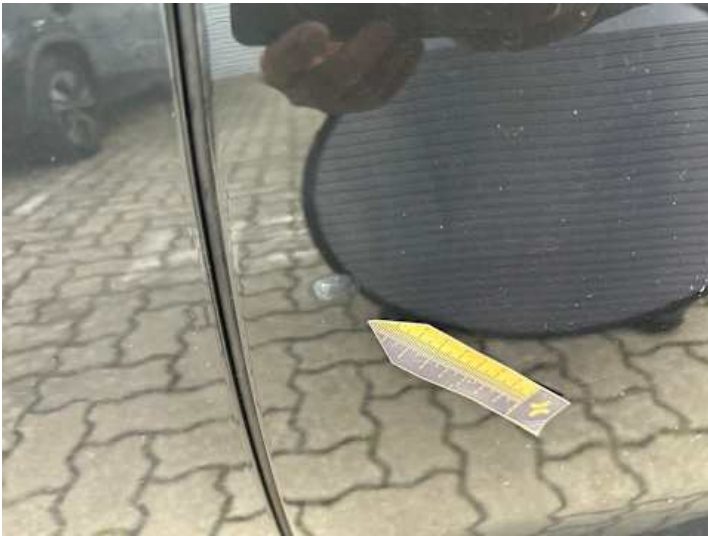
Türe hinten links (Lackschaden)
