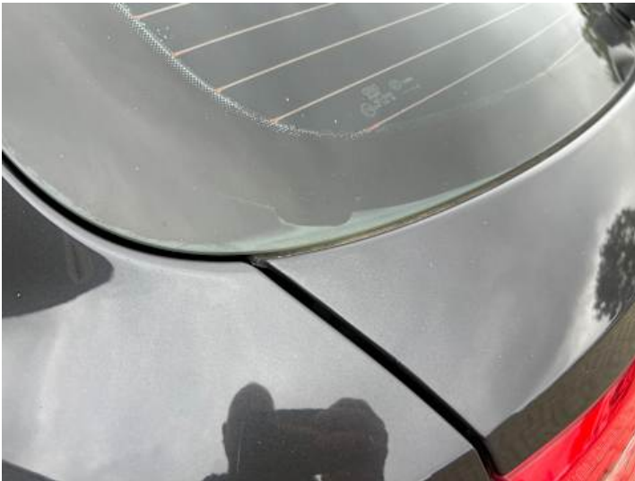
Rückscheibe (Anderer Schaden): Ablösung
