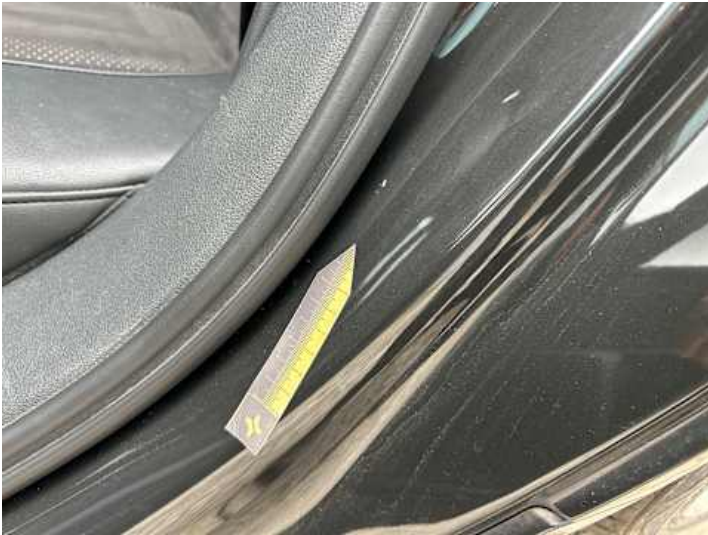
Schweller links (Kratzer)
