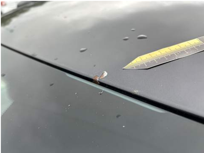
Dach (Steinschlag, Lackschaden)
