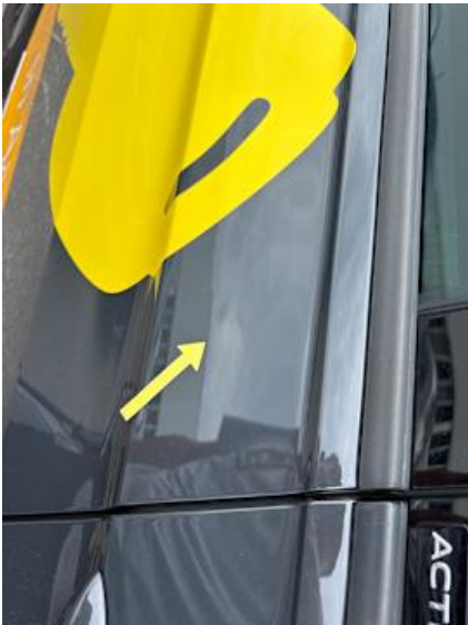
Türe hinten rechts (Kratzer)
