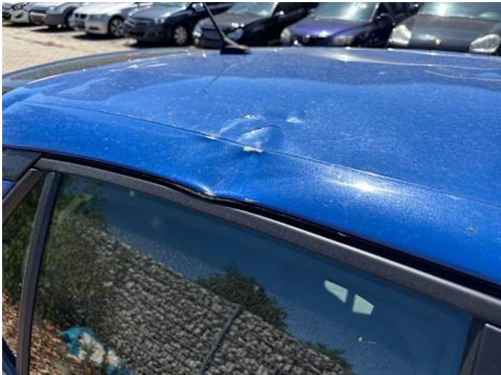
Dach (Verformung, Delle)
