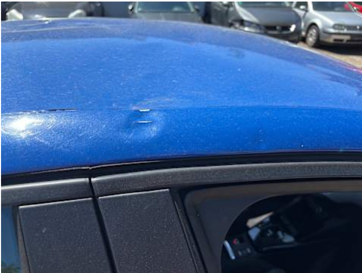
Dach (Verformung, Delle)
