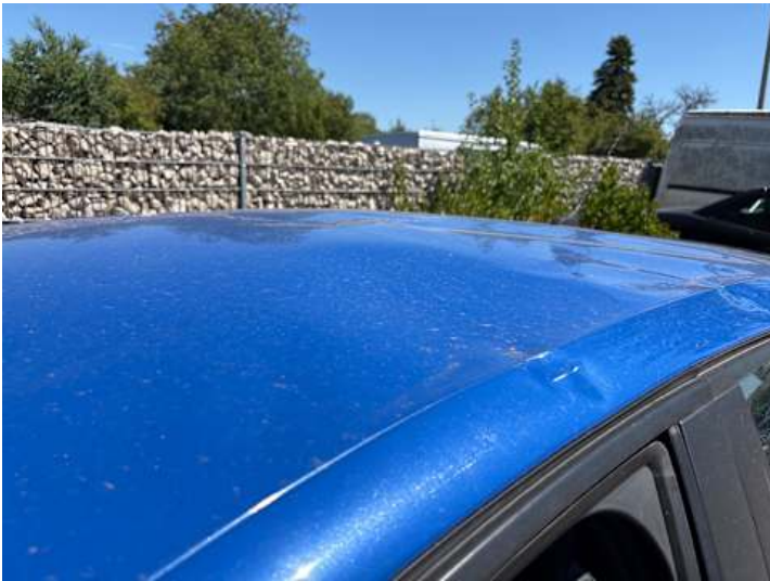
Dach (Verformung, Delle)
