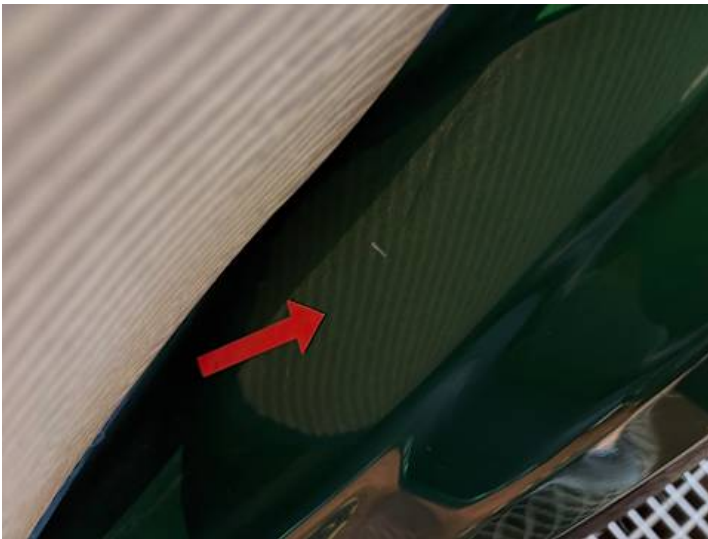
Türe hinten links (Kratzer, Delle)
