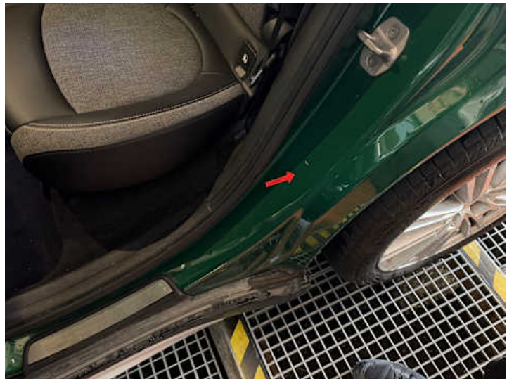
Türe hinten links (Kratzer, Delle)
