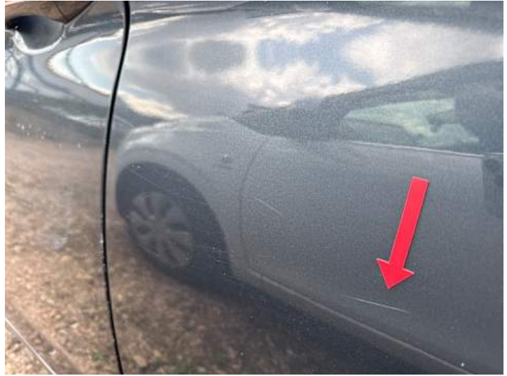
Türe hinten links (Kratzer)
