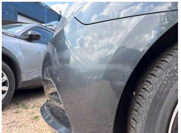
Stoßstange vorne (Spaltmaße ungenau, Lackschaden, Riss/Bruch)
