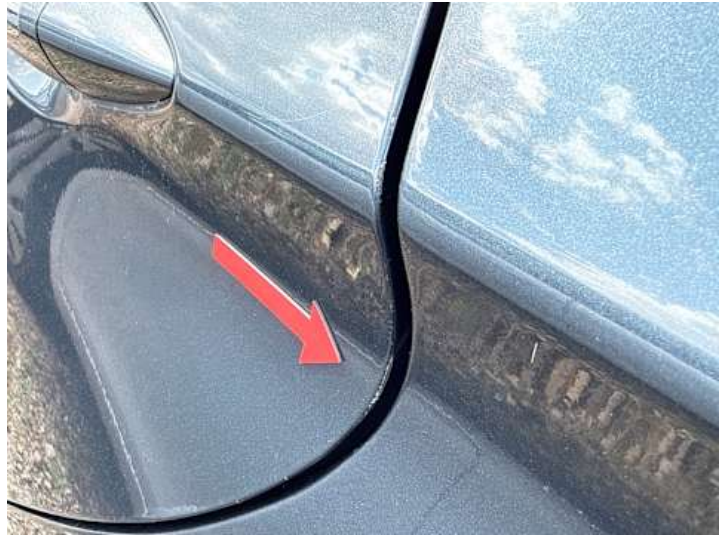
Türe hinten links (Lackschaden)
