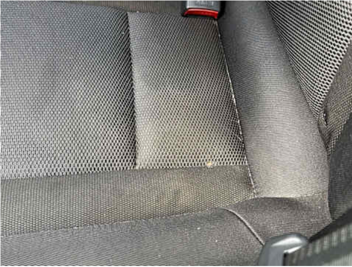
Innenraum (Verschmutzung, Brandloch, Verschleiß)
