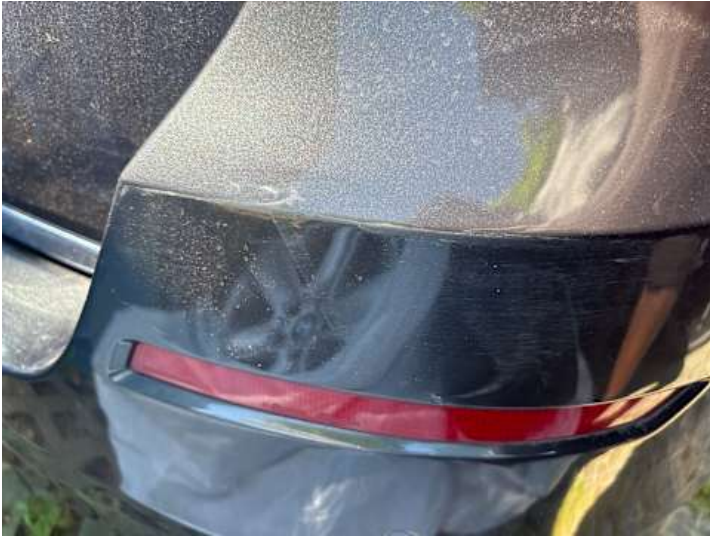
Stoßstange hinten (Kratzer)
