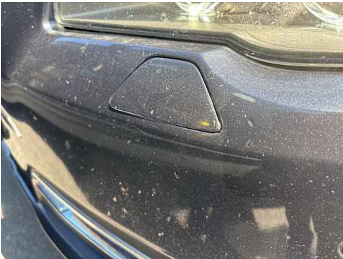
Stoßstange vorne (Steinschlag)
