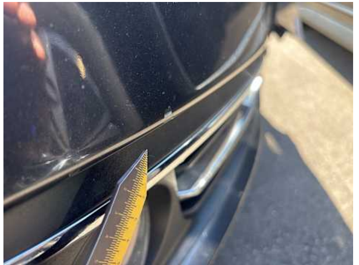
Stoßstange vorne (Steinschlag)
