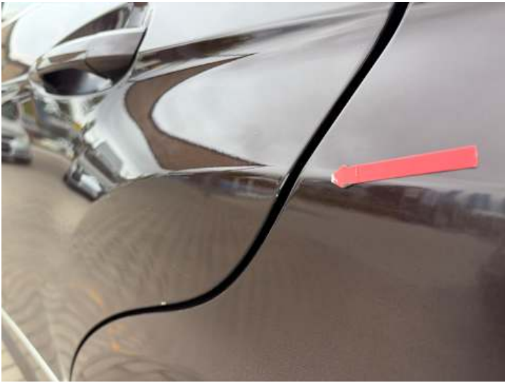
Türe hinten links (Lackschaden)
