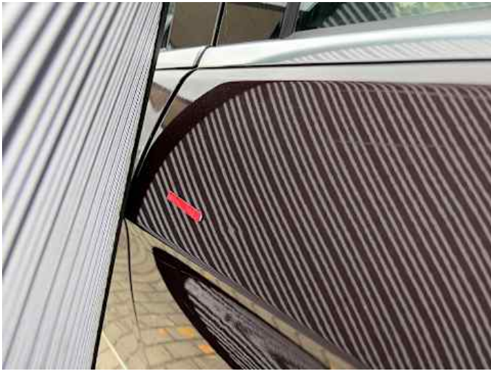
Türe hinten links (Delle)
