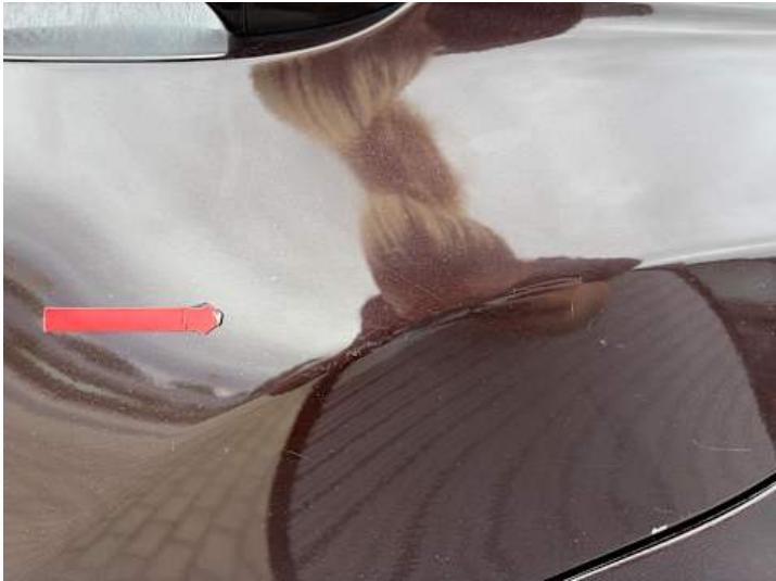
Türe hinten links (Lackschaden)
