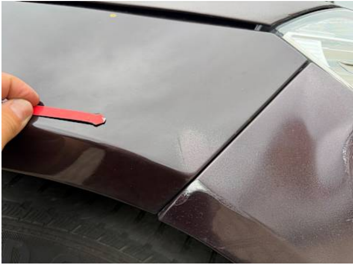
Kotflügel vorne rechts (Unsachgemäß instand gesetzt)
