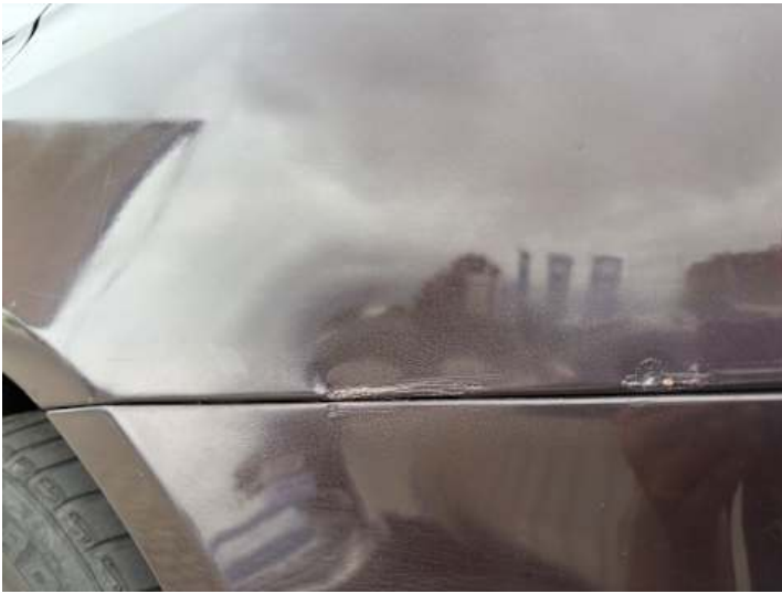
Seitenteil hinten links (Rost, Ausgeblichen/Matt)
