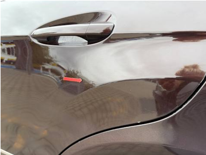
Türe hinten links (Lackschaden)
