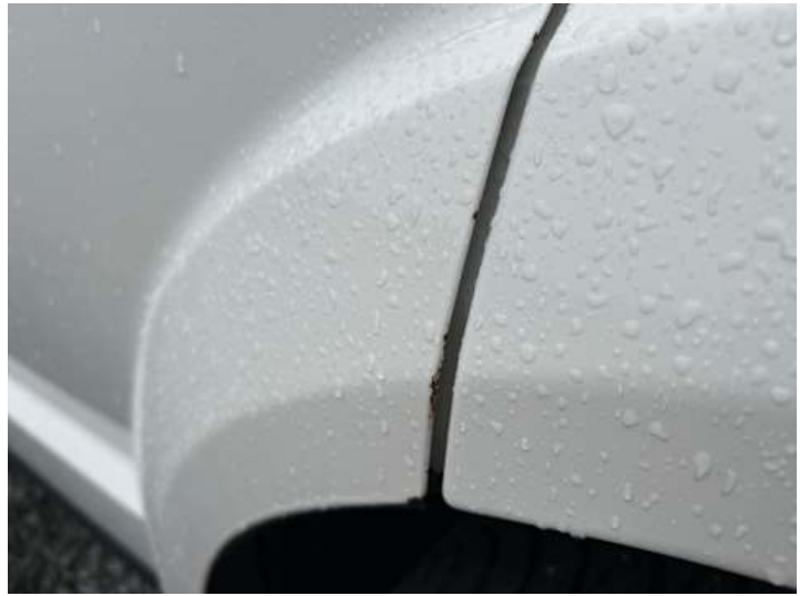
Türe hinten links (Kratzer, Lackschaden, Rost)
