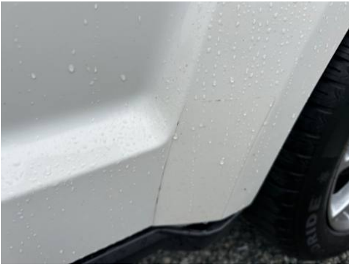
Türe hinten links (Kratzer, Lackschaden, Rost)
