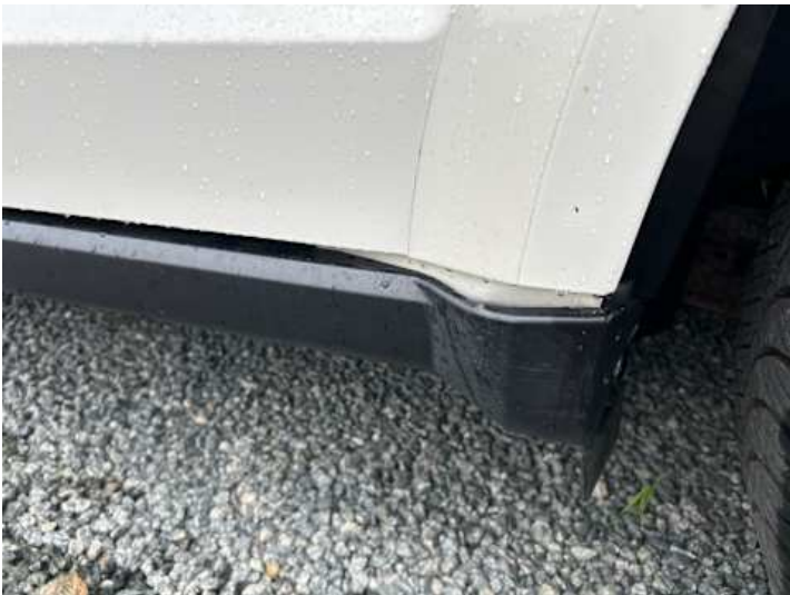
Schweller links (Kratzer, Spaltmaße ungenau)
