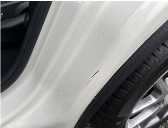
Türe hinten links (Kratzer, Lackschaden, Rost)
