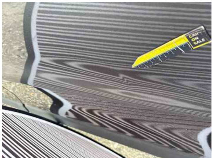
Türe hinten links (Verformung)
