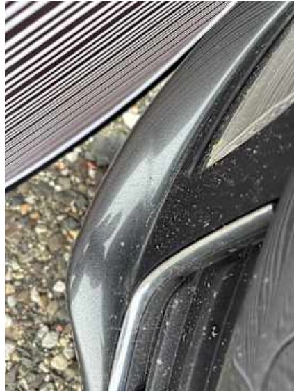
Stoßstange vorne (Verformung)
