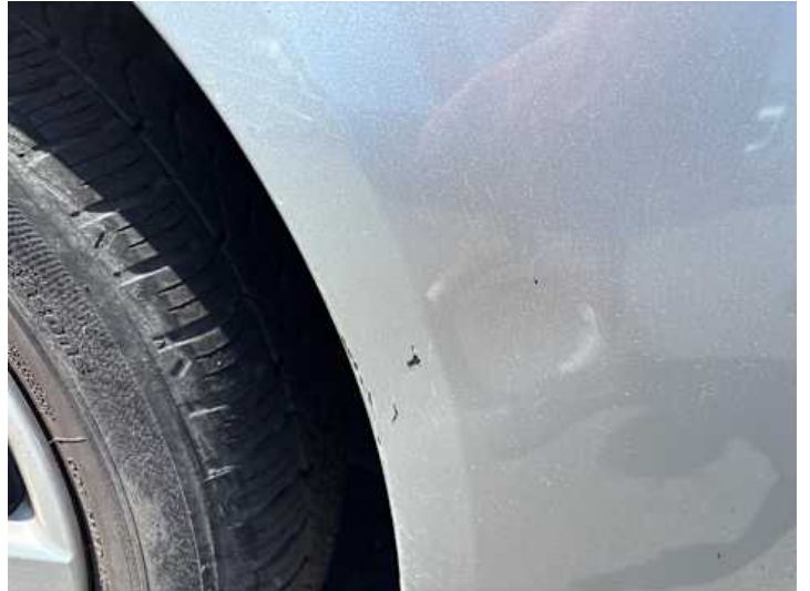
Stoßstange vorne (Kratzer, Unsachgemäß instand gesetzt)
