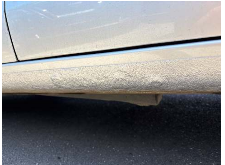
Schweller links (Rost)
