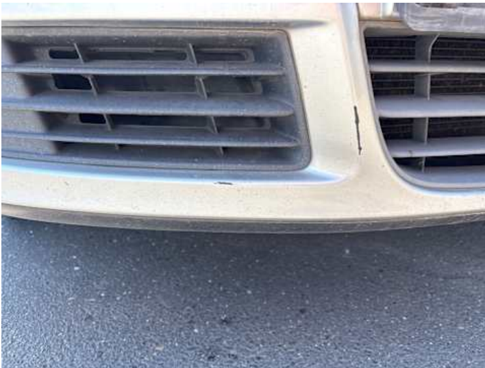
Stoßstange vorne (Kratzer, Unsachgemäß instand gesetzt)
