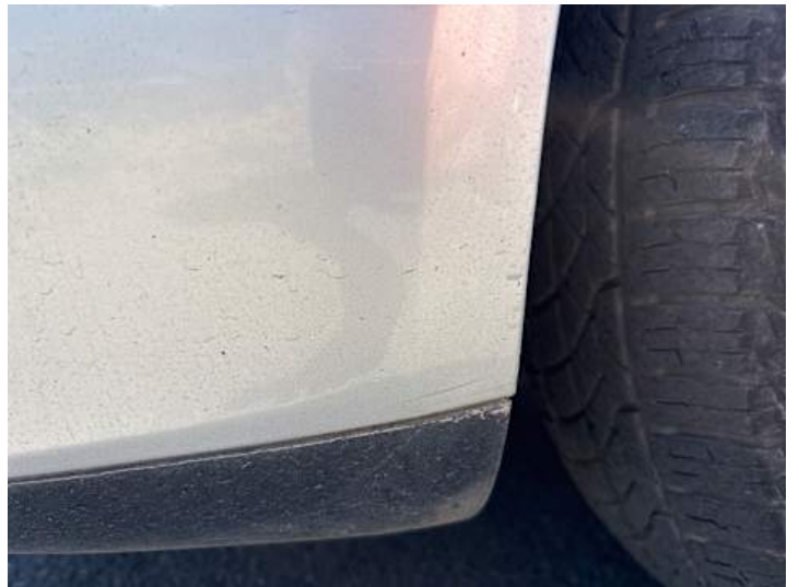
Stoßstange vorne (Kratzer, Unsachgemäß instand gesetzt)
