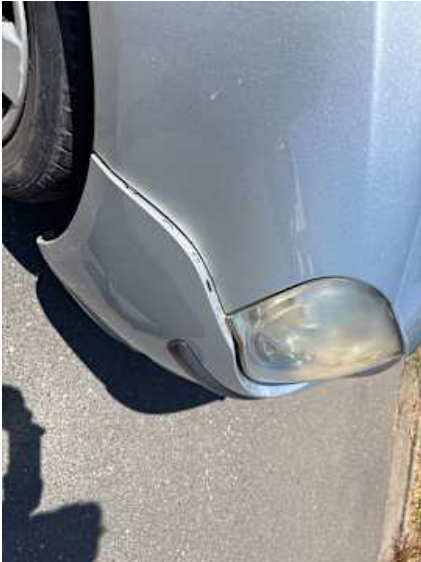
Stoßstange vorne (Kratzer, Unsachgemäß instand gesetzt)
