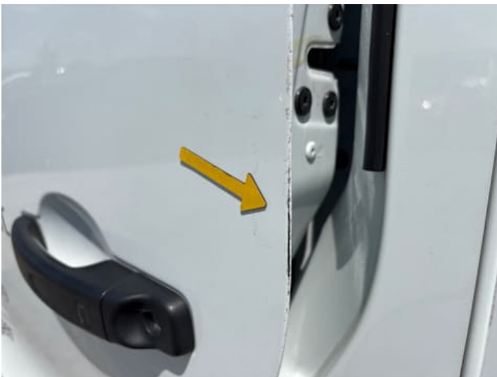
Fahrertür (Delle, Kratzer, Lackschaden)
