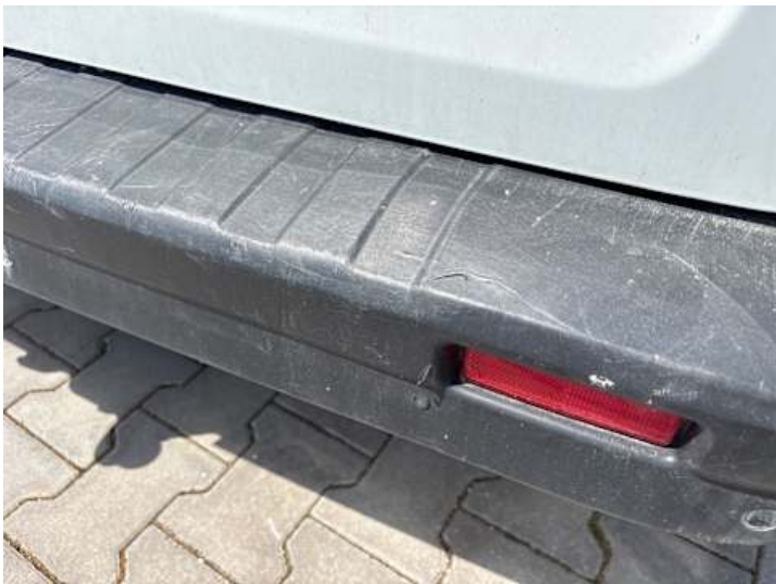
Stoßstange hinten (Kratzer, Verformung, Riss/Bruch)
