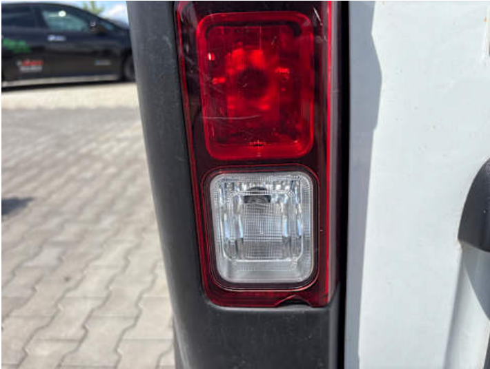
Rücklicht (links) (Riss/Bruch, Kratzer)
