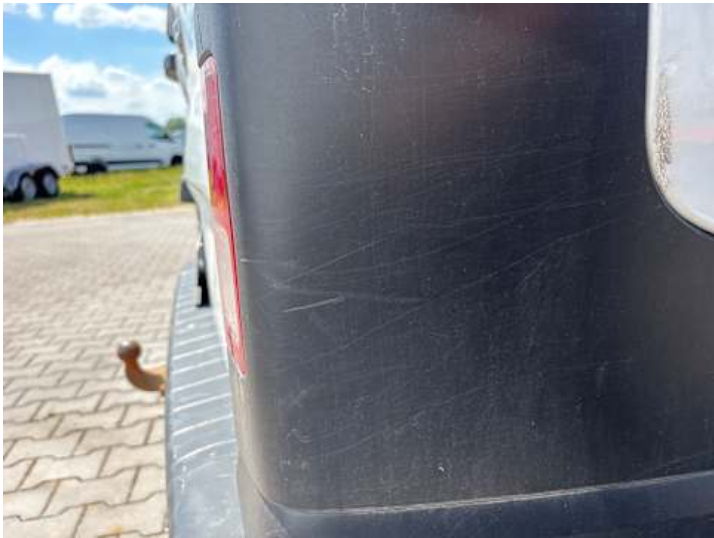
Stoßstange hinten (Kratzer, Verformung, Riss/Bruch)
