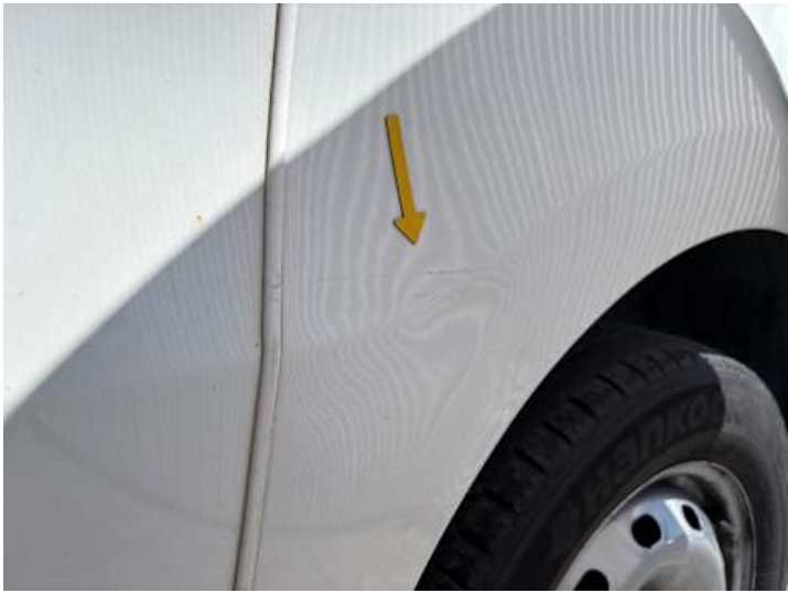
Seitenteil hinten links (Verformung, Kratzer, Lackschaden)
