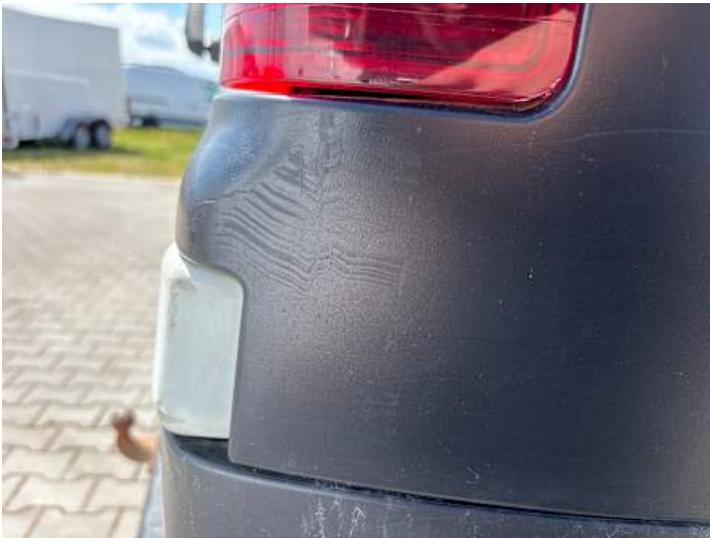
Stoßstange hinten (Kratzer, Verformung, Riss/Bruch)
