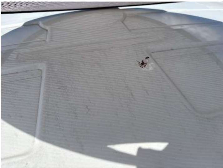
Dach (Delle, Lackschaden, Steinschlag, Verformung)
