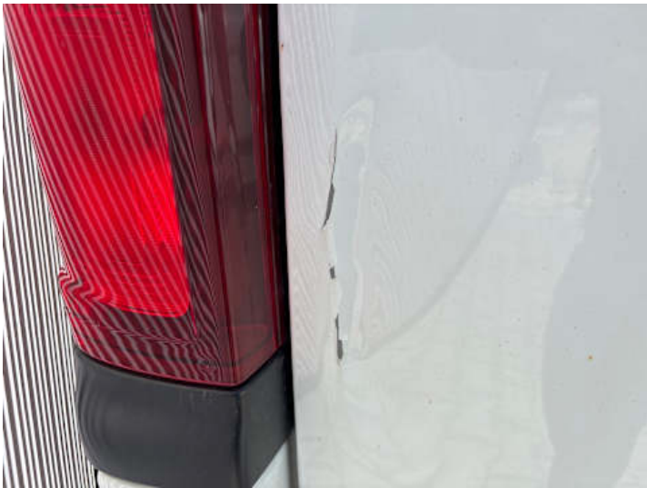
Heckklappe (Lackschaden, Rost, Verformung, Delle, Unsachgemäß instand gesetzt)
