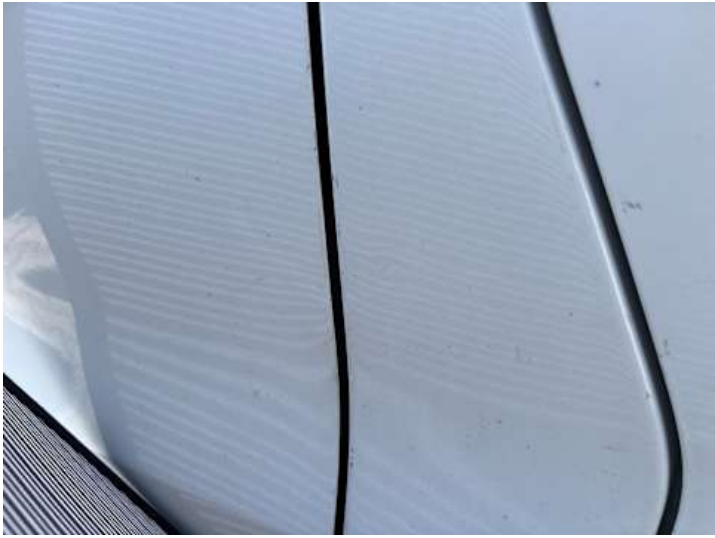
Seitenteil hinten rechts (Delle, Lackschaden, Kratzer, Rost)
