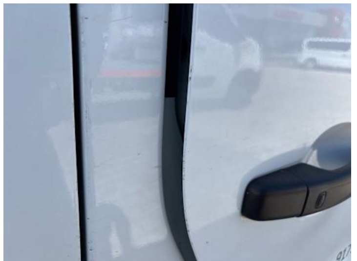
Beifahrertür (Lackschaden, Kratzer)
