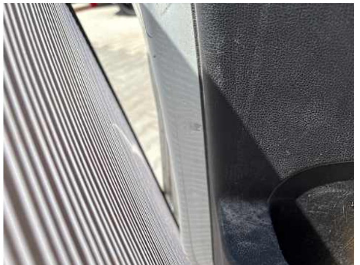
Fahrertür (Delle, Kratzer, Lackschaden)
