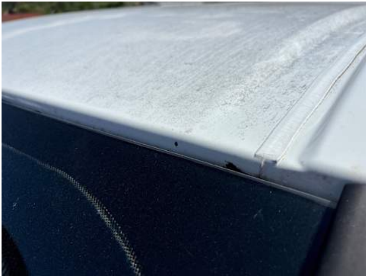
Dach (Delle, Lackschaden, Steinschlag, Verformung)
