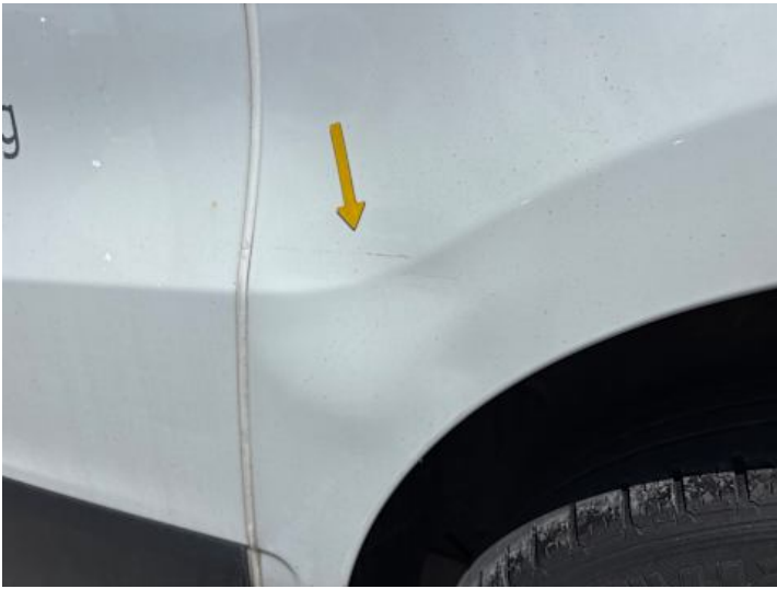
Seitenteil hinten links (Verformung, Kratzer, Lackschaden)
