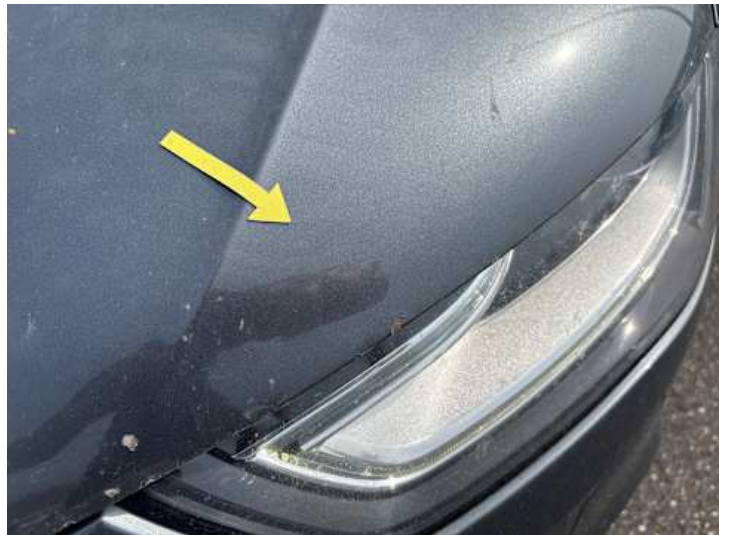
Motorhaube (Lackschaden, Rost)
