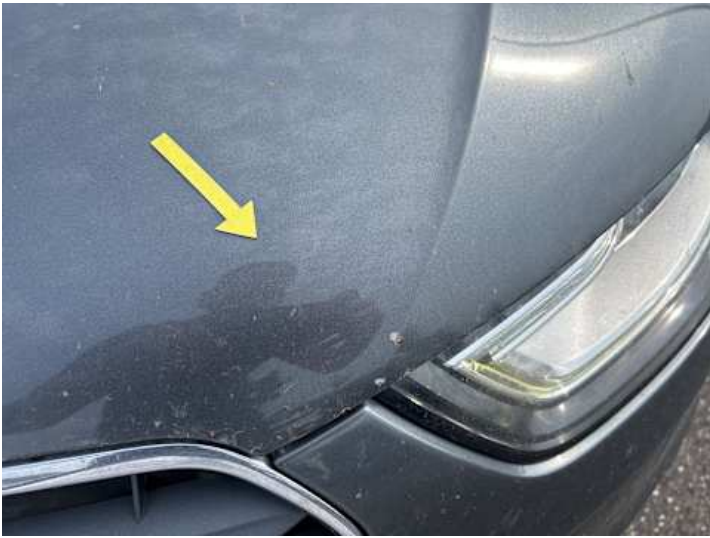
Motorhaube (Lackschaden, Rost)
