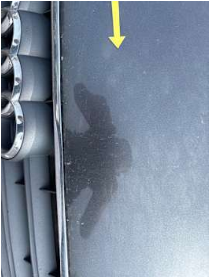
Motorhaube (Lackschaden, Rost)
