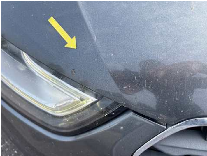
Motorhaube (Lackschaden, Rost)
