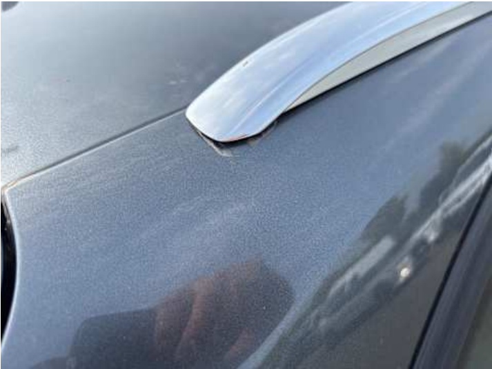
Seitenteil hinten rechts (Lackschaden)
