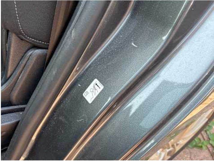
Seitenteil hinten links (Lackschaden)
