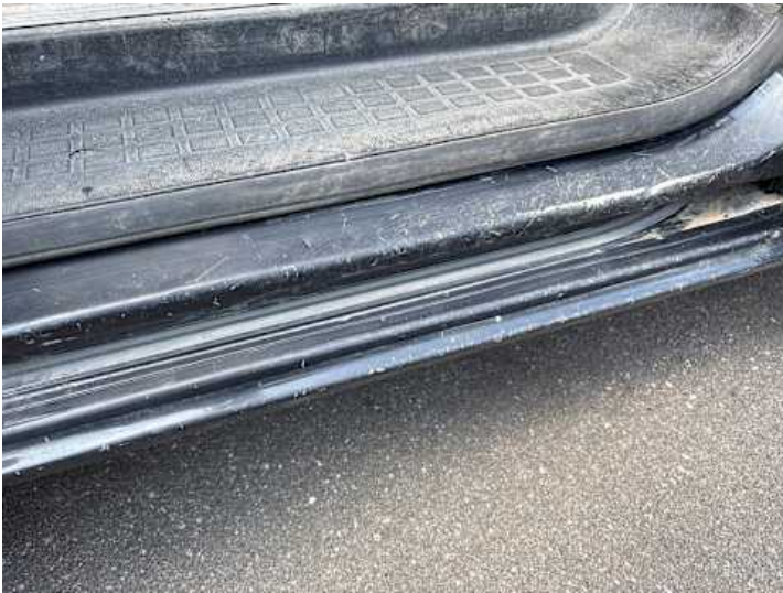
Schweller rechts (Lackschaden)
