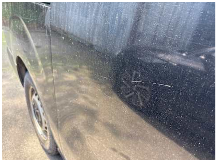
Türe hinten rechts (Kratzer)
